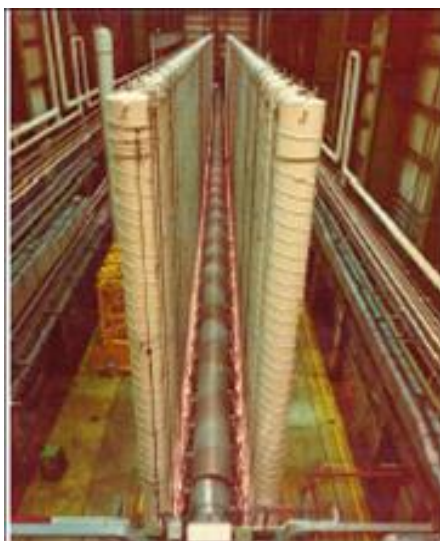
Рис.5.6. Участок опытного каскада американских центрифуг
