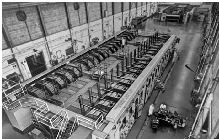
Рис.3.3. Установка электромагнитного разделения изотопов (“рейстрек”) в Ок-Ридже
