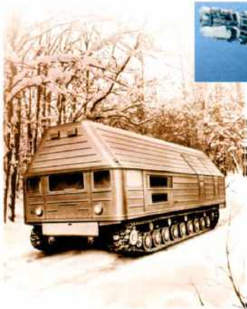
Транспортируемая атомная энергетическая установка ТЭС-3
