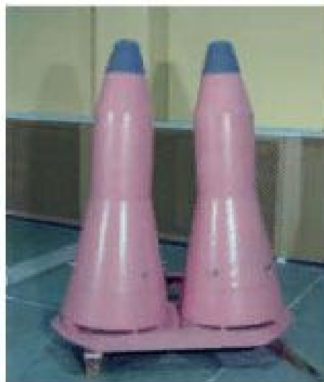
Первый боевой блок разделяющейся головной части с индивидуальными наведениями ББ на точки прицеливания
