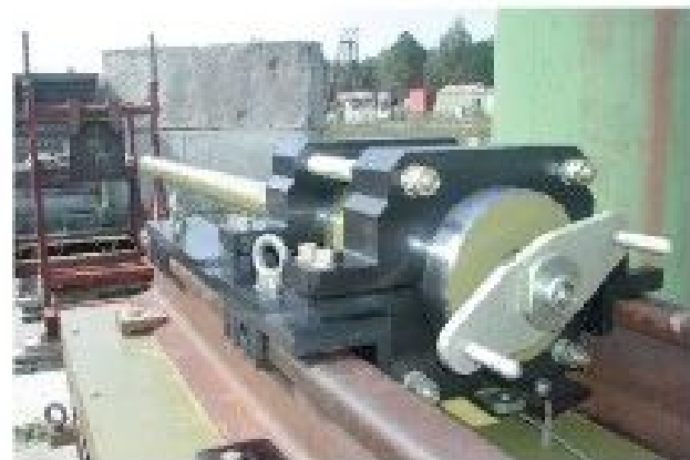
Вид участка пуле-осколочного стенда с пороховой металальной установкой
