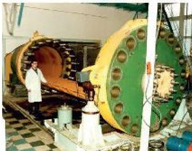
Общий вид гидрокамеры для проведения испытаний изделий на глубоководное затопление
