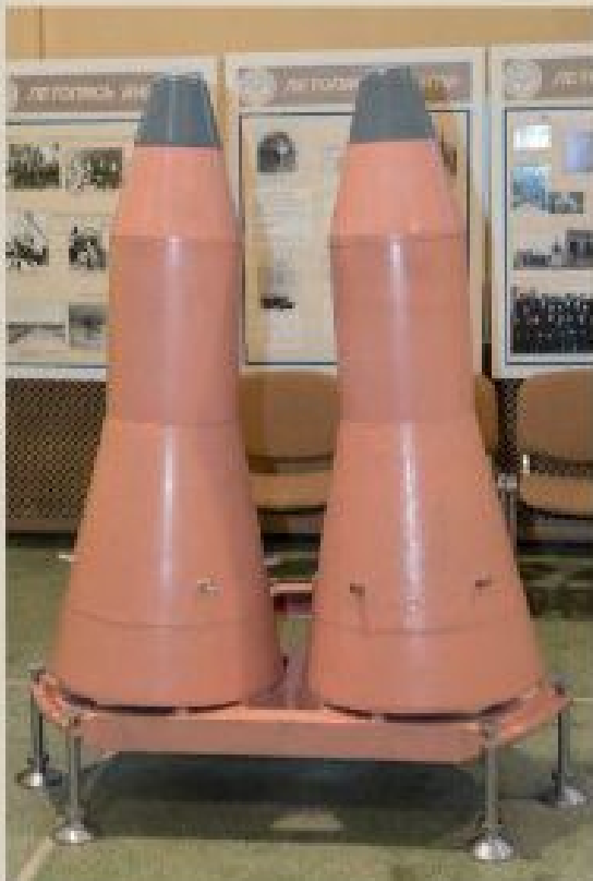
Моноблочная головная часть с системой пассивного самонаведения с баллистической коррекцией траектории полета
