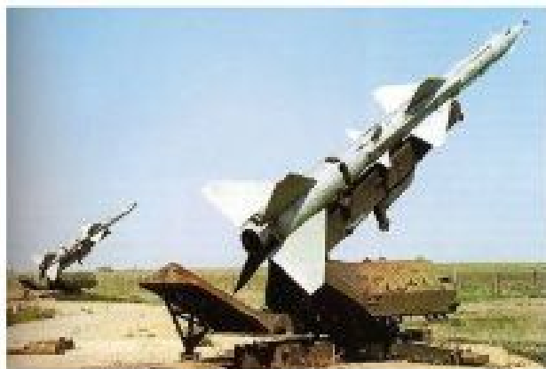
Пусковая установка комплекса С-75
