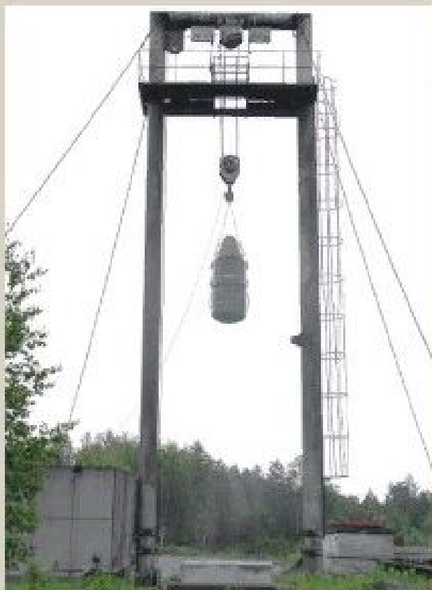
Копровая установка для сброса изделий
