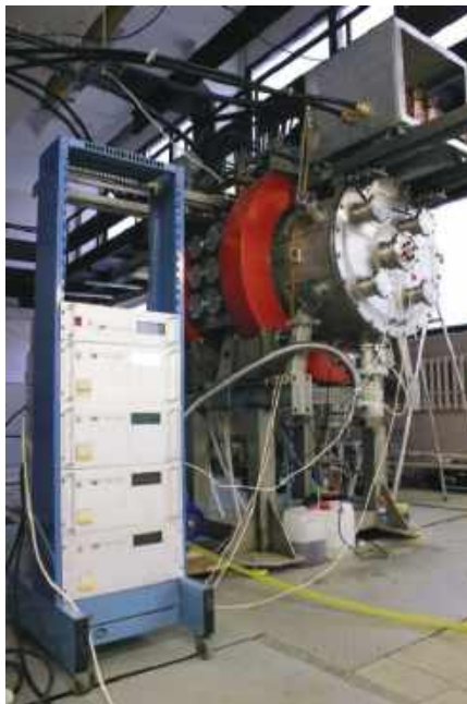
Рис. 16.10. Внешний вид экспериментального стенда для отработки метода плазменной сепарации веществ, моделирующих ОЯТ
