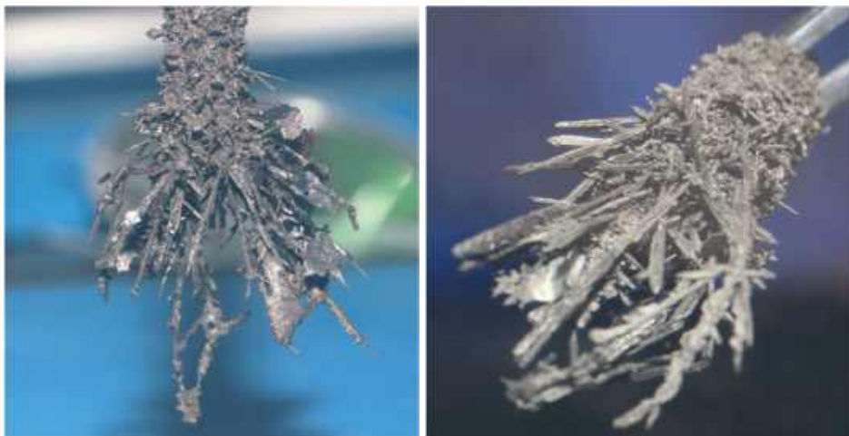
Рис. 16.5. Фотографии катодного осадка до (слева) и после (справа) очистки от хлоридного электролита методом отгонки
