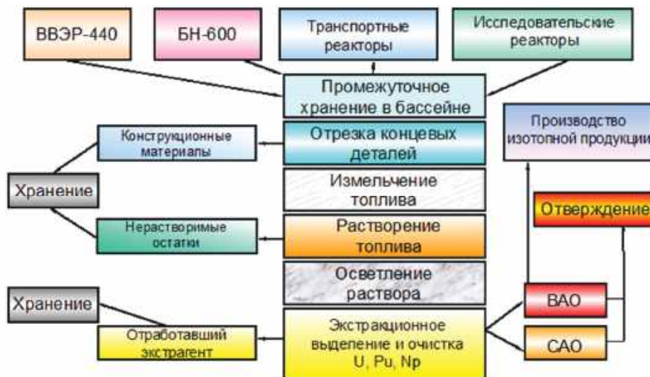
Рис. 16.1. Технологическая схема переработки ОЯТ на РТ-1
