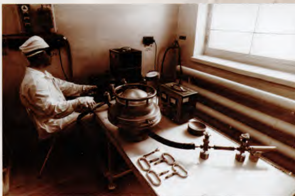
Цех №77. Рабочее место проверки герметичности супероболочек
