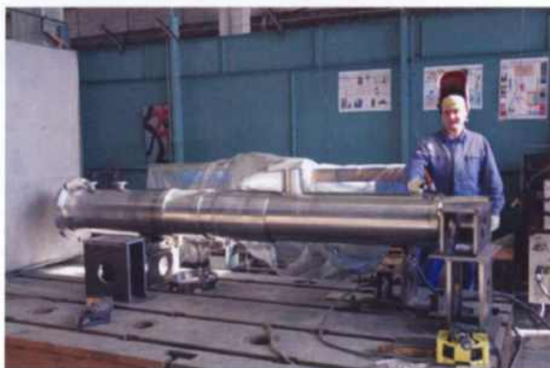
Фрагмент корпуса реактора ИБР-2 в процессе изготовления
