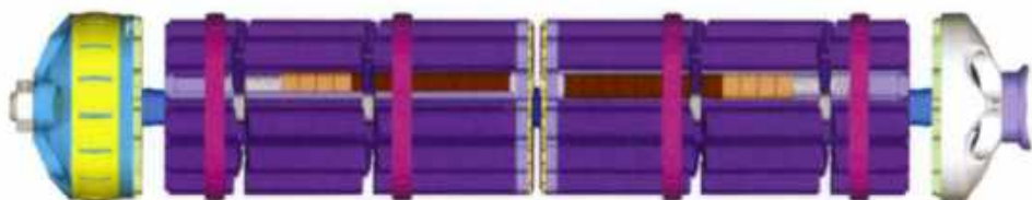
ТВС РБМК-1000 с высотным профилированием обогащения топлива, хвостовиком-фильтром и центральным закреплением ТВЭЛОВ (ТВС-ПФЦ)
