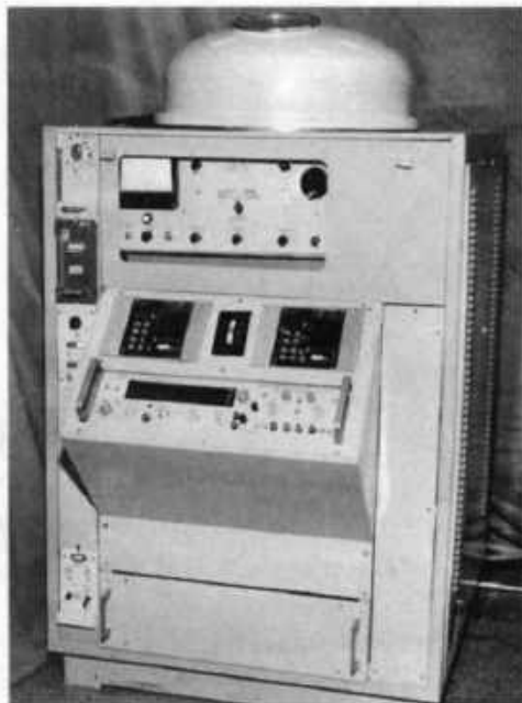
Установка ионного травления и магнетронного напыления для настройки частоты кварцевых резонаторов «Корень-2»
