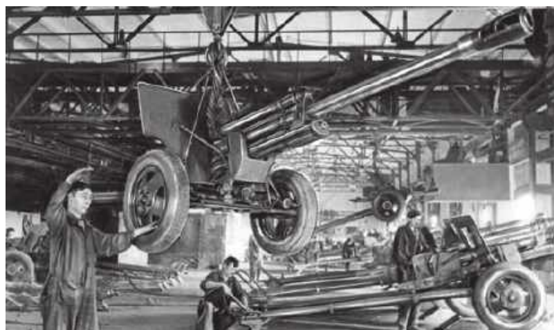
Сборка орудия ЗИС-2 на заводе имени Сталина
