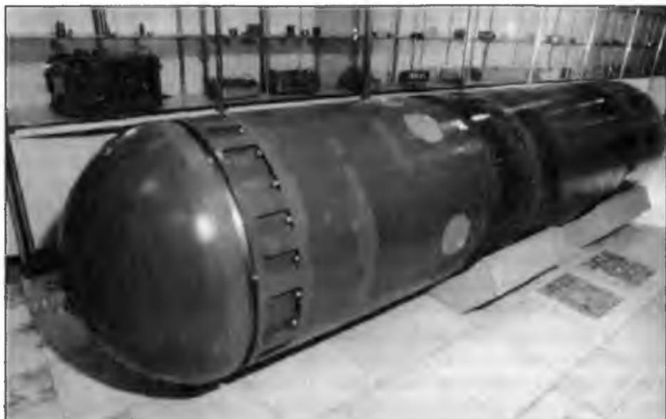
Рис. 3.2. Ядерное взрывное устройство большой мощности, предназначенное для проведения взрывов с выбросом грунта.
