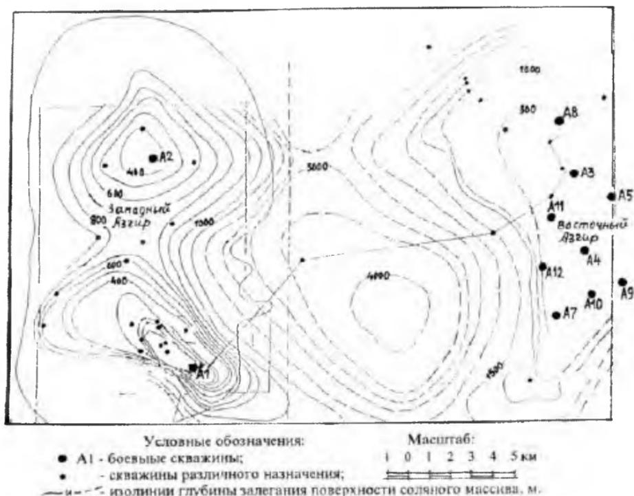
Рис. 7.3. Карта-схема расположения подземных ядерных взрывов на солянокупольном месторождении Большой Азгир (площадка "Галит")
