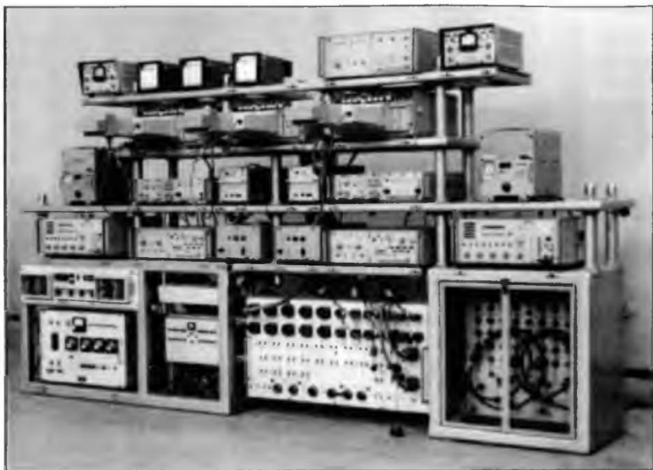
Рис. 3.8. Разборный комплекс аппаратуры для регистрации физических параметров взрыва ядерного заряда.
