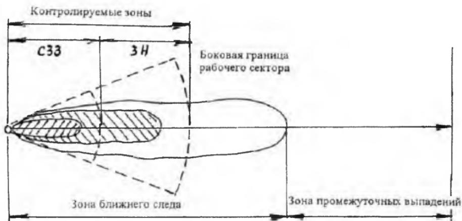
Рис. 4.3. Схема зонирования территории при подготовке и проведении подземного ядерного взрыва с выбросом грунта.
