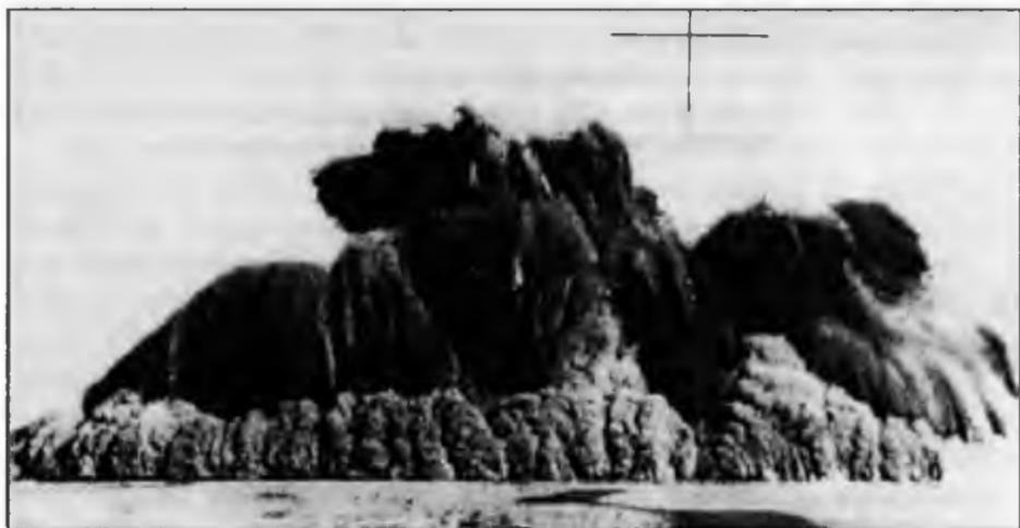
Рис. 6.8. Развитие выброса грунта и облака группового ядерного взрыва «Телькем-2» (3x0,24 кт); общий вид через 6,5 сек после детонации зарядов
