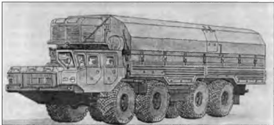
Рис. 3.3. Унифицированная машина НГЗП1 для транспортировки, хранения и сборки промышленных ядерных зарядов средней и большой мощности.
