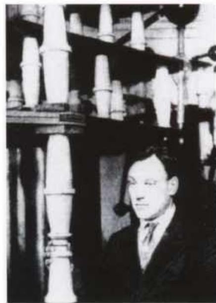
А.И. Лейпунский у генератора высокого напряжения, с помощью которого было расщеплено атомное ядро лития
