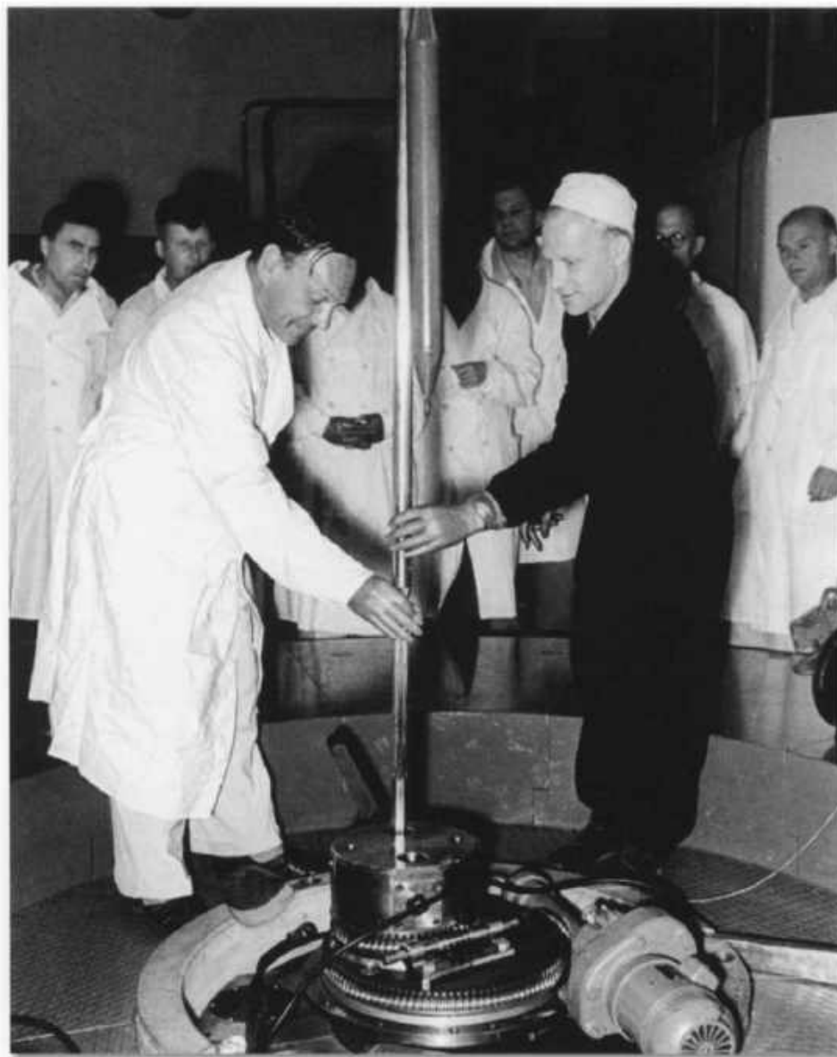
«Сухой» (без теплоносителя) физический пуск реактора БР-5. А.И. Лейпунский и В.Н. Лебедев загружают тепловыделяющую сборку (ТВС) в активную зону реактора ручным захватом». Лаборатория «В», июль 1958 г.
