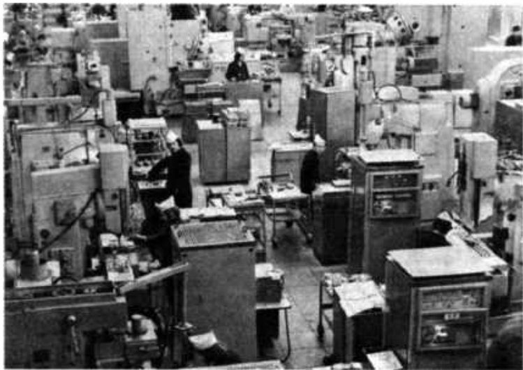
Механообрабатывающее производство. Участок фрезерных станков с ЧПУ
