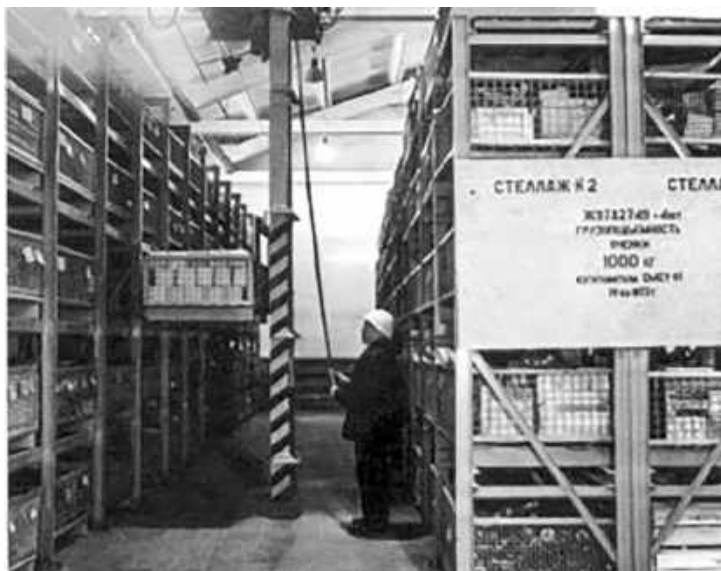
Механизированный склад с кран-штабелером разработки отдела 065
