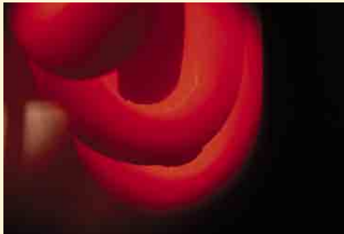
Процесс в реакторе водородного восстановления — кремний из хлорсиланов осажается на раскаленные стержни основы
