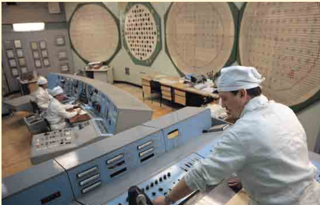
Тренажер для обучения инженеров управления реактором
