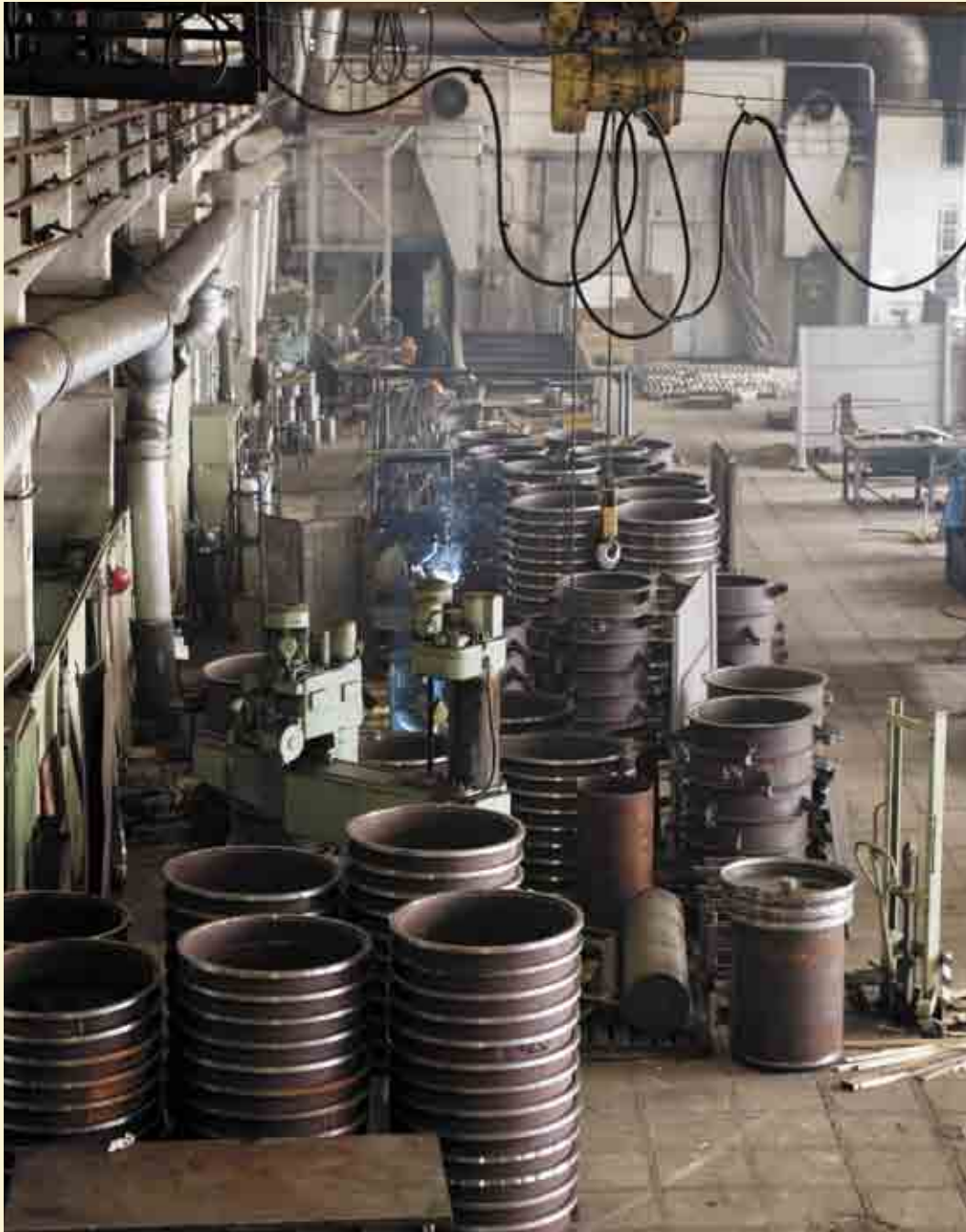
Ремонтно-механический завод — производство «пробок» для гнезд хранения ХОТ-2
