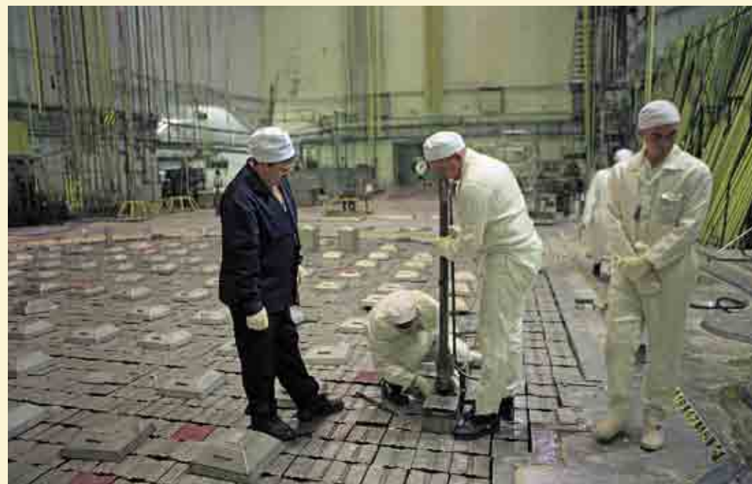
Загрузка технологического канала урановыми блоками
