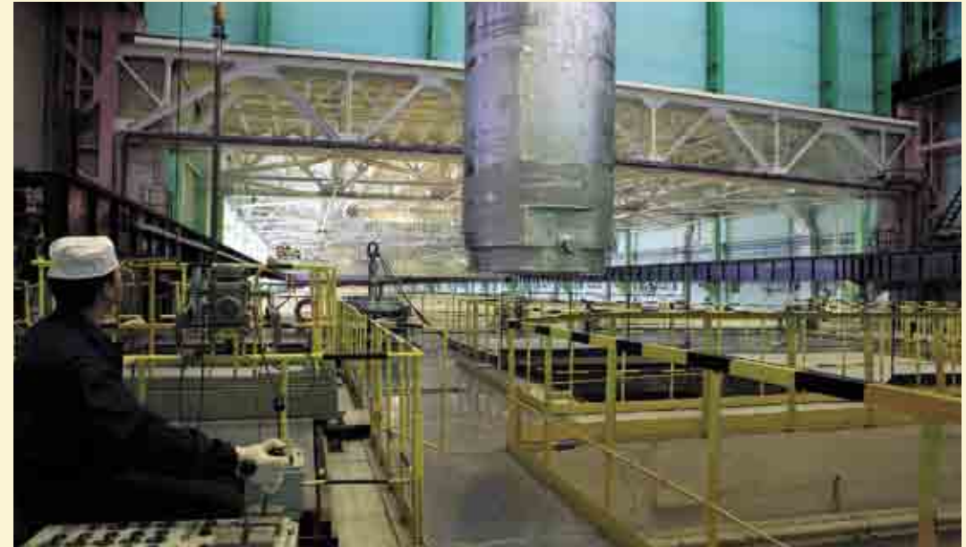
Установка транспортного контейнера в ванну для отмывки. Толщина стенки стального контейнера 35 сантиметров, вес около 100 тонн
