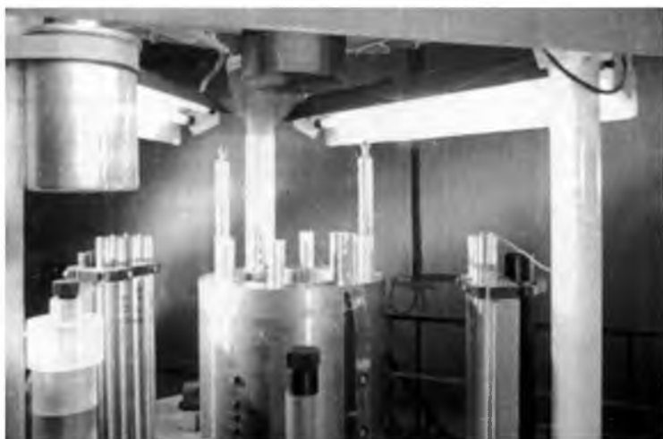
Критический стенд для исследований нейтронно-физических характеристик реактора «Ромашка»
