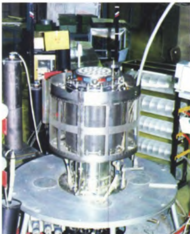
Нейтронно-физический стенд «Нарцисс» с прототипом реактора «Енисей»
