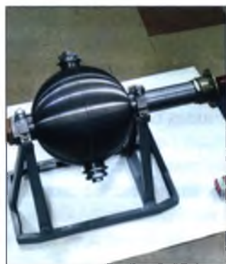
Разрушающийся импульсный реактор и ампула для деструктивных испытаний (ВНИИЭФ, г. Саров).
