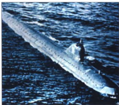
Первая советская АПЛ проекта 645 со свинцово-висмутовыми реакторами
