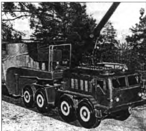
Мобильные ядерные установки СССР: ТЭС-3 (1961 г.), Памир-630-Д (1986 г.)
