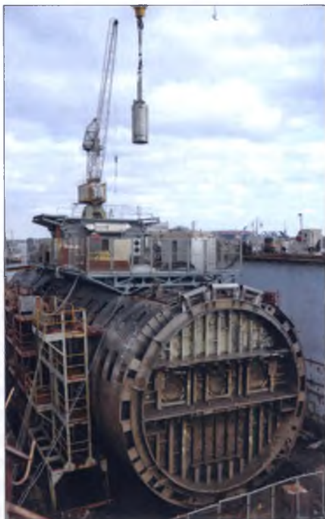
Выгрузка ОЯТ из реакторного отсека, 2014 год»
