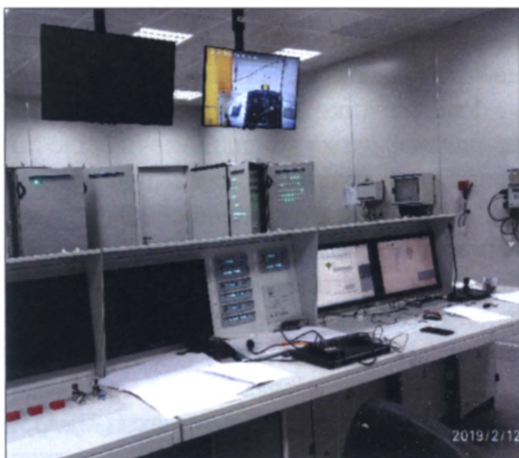
Критический стенд направления ВВЭР (справа – модернизированный пульт управления)
