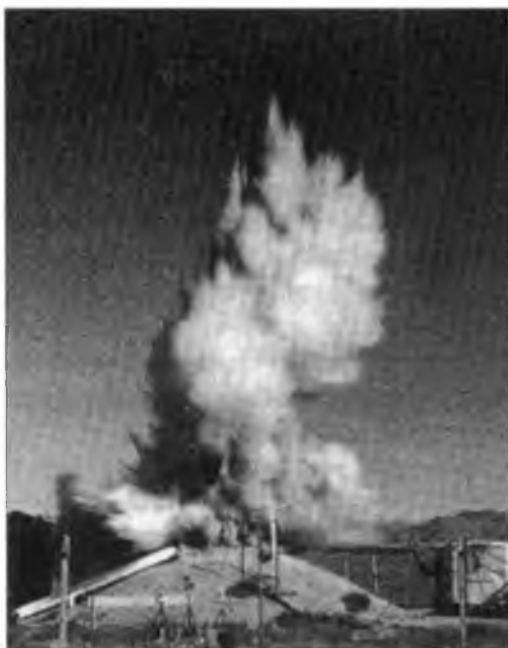
Деструктивные испытания реактора BORAX-1, 1954 год
