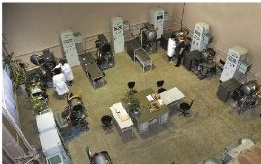
Вакуумные электропечи участка термической обработки
