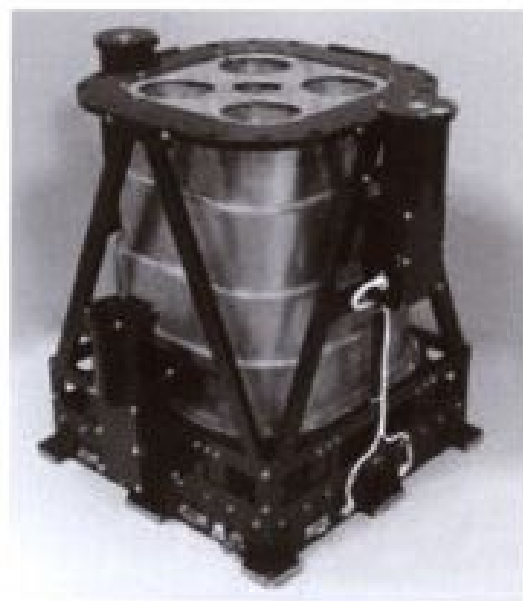
Технический эскиз (а) и внешний вид (б) прибора «ЛЕНД» без слоя экранно-вакуумной термозащиты
