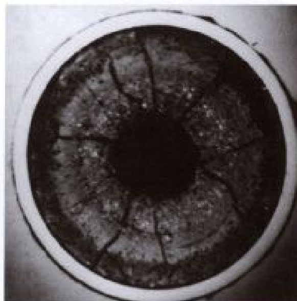
Микро- (слева) и макроструктура (справа) сечения ТВЭЛА, облучённого в центре активной зоны реакторе БОР-60 до выгорания 32 % т. а.
