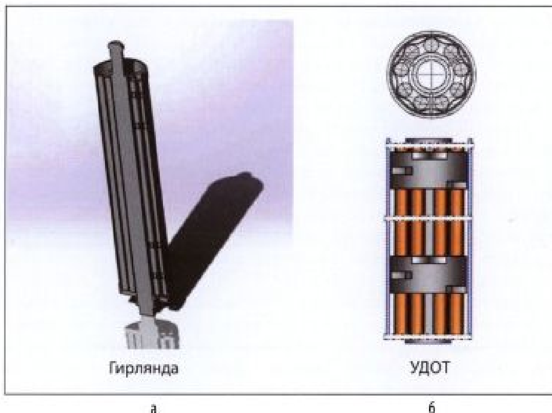
а б Схема и сечения облучательных устройств типа «Гирлянда», применяемых для облучения (а) и дооблучения (б) твэлов
