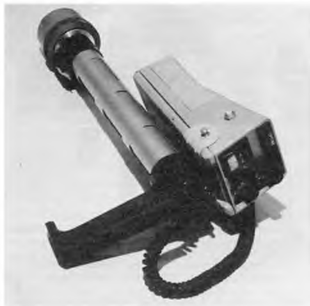
Переносной радиометр СРП-88НМ, предназначенный для поиска месторождений радиоактивных руд, использования на загрязненных территориях для контроля радиационного фона и определения прижизненного содержания цезия в животных для предотвращения выпуска загрязненных продуктов на мясокомбинатах
