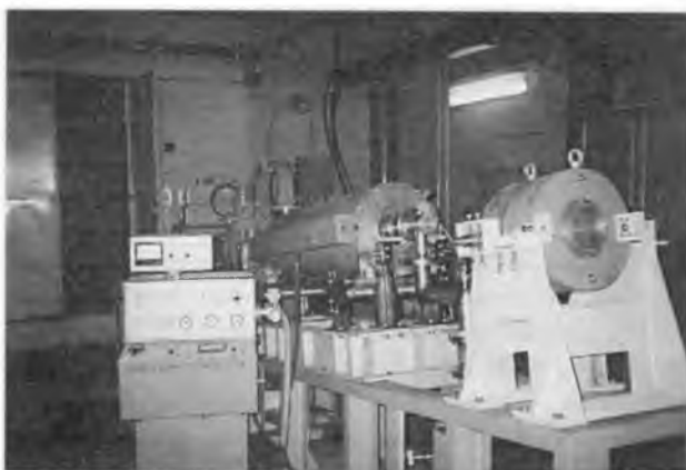
Линейный ускоритель радиографического таможенного комплекса
