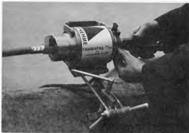
Гамма-дефектоскоп сварных швов с источником иридий-192
