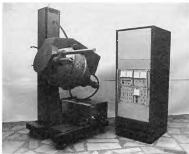
Нейтронный генератор постоянного потока НГМ-14 с запаянной трубкой
