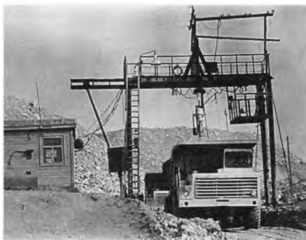
Рудоконтролирующая станция РКС-1 с рентгено-радиометрическим анализатором для контроля руд в самосвалах
