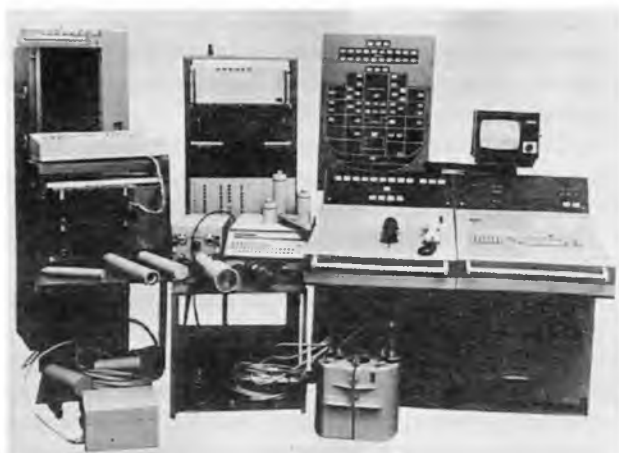
Технические средства корабельных систем радиационного контроля атомных ледоколов, контейнеровозов, лихтеровозов и т. п.
