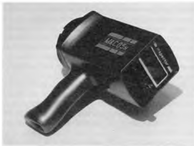
Переносной радиометр-дозиметр МКС-05Н («Инспектор»), предназначенный для измерения мощности эквивалентной дозы внешнего \gamma -излучения, плотности потока \beta -частиц от загрязненности поверхности, а также удельной (объемной) активности \beta -излучающих нуклидов в пробах
