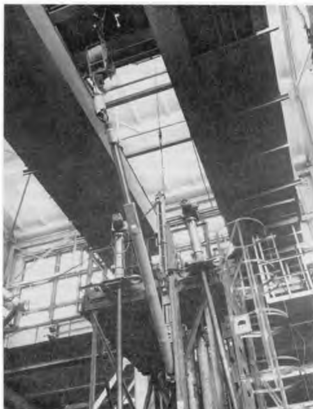
Стенд на опытном производстве института для отладки и проверки ремонтного оборудования реакторов РБМК
