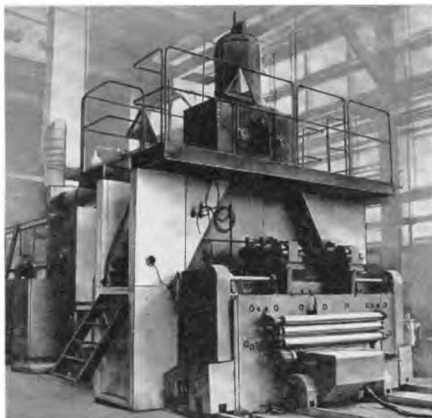
Промышленная установка с ускорителем электронов для облучения хлопчатобумажных тканей в целях придания им антимикробных свойств
