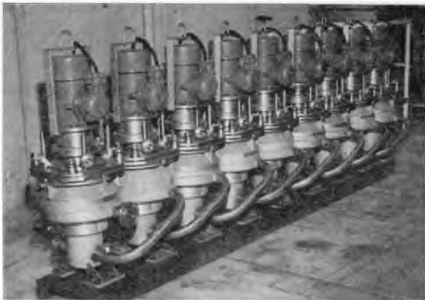
Девятиступенчатый центробежный экстрактор
