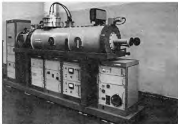
Демонстрационная секция протонного ускорителя с высокочастотной квадрупольной фокусировкой. Ускоритель такого типа впервые предложен и изготовлен в ИФВЭ. Может применяться как для задач физики высоких энергий (как инжектор), так и для прикладных задач
