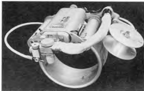
Трубопаяльный аппарат «Минора» для сварки труб диаметром от 50 до 1200 мм
