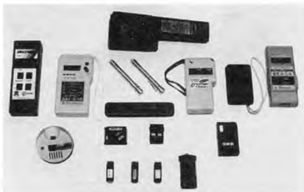
Индивидуальные и бытовые дозиметры: прямопоказывающие («Эксперт», ДКГ-01И, ДК-02, «Юпитер», «Белла», RSM-101, ИРД-02Б); сигнальные («Щелкунчик», «Сверчок-1», «Сверчок-2», RM-121), термолюминесцентные (кассеты приборов КИД-7, ДПГ-02, ДПГ-03, ДПС-11, КДТ-02 и др.)
