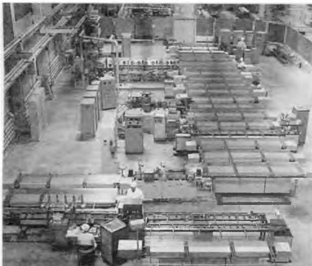
Автоматизированная линия изготовления твэлов РБМК
