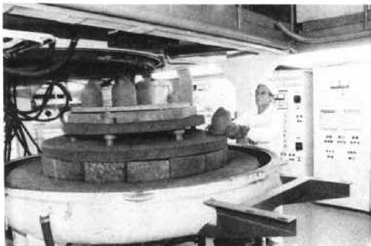
Высокотемпературная печь для термообработки зеркал из карбида кремния и ее «хозяин» В. М. Поляков
