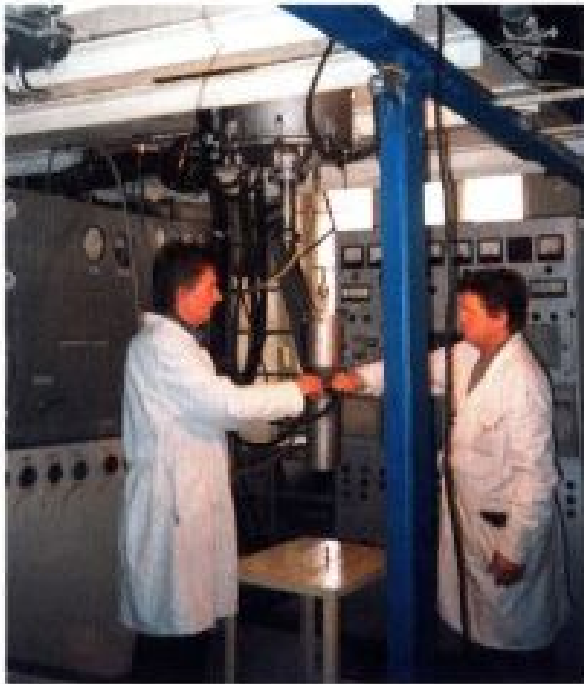
Установка для нанесения покрытий из пироуглерода и карбида кремния на сферические топливные частицы (на переднем плане слева — ведущий разработчик технологии микротвэлов С.Д. Курбаков и нач. группы Г.В. Ивановский)
