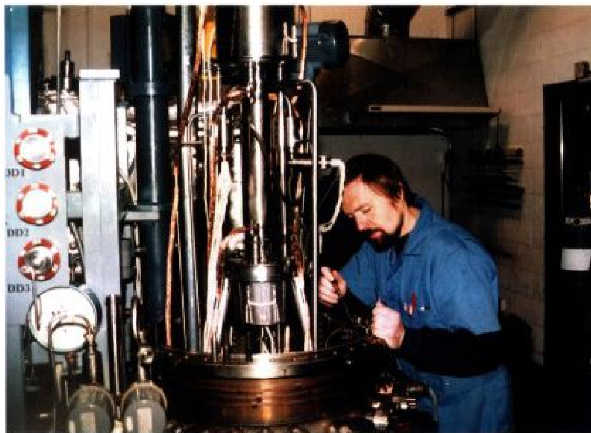
Город Альбукерк. Университет Нью-Мексико. У стенда тепловых испытаний ЭГК установки Топаз-2 В.Н. Андросов
