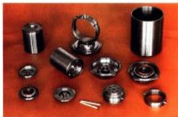
Детали изделия из бериллия, приготовленные методом выдавливания
