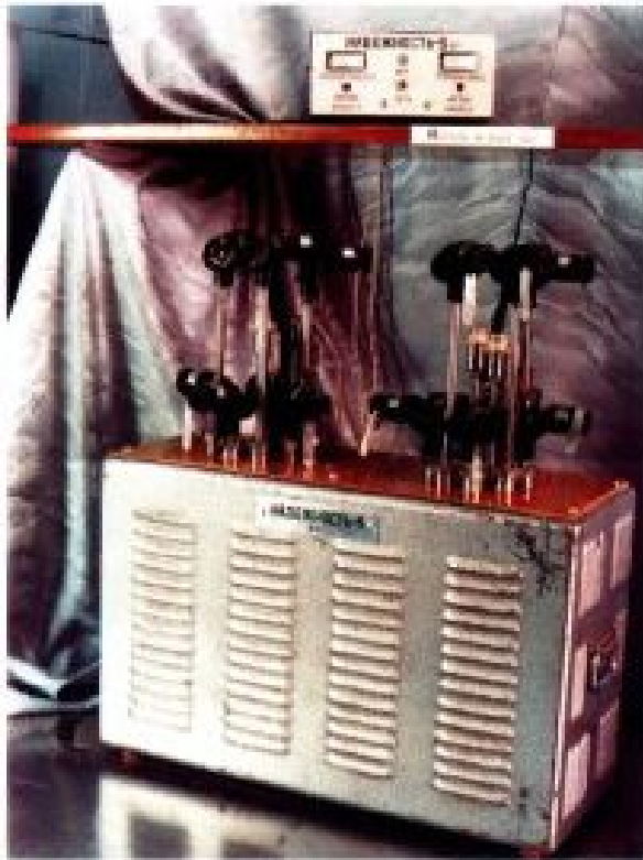
Стенд «Параметр» для испытания термопар, их сборок в условиях, имитирующих различные стадии проектных и запроектных аварий реакторов ВВЭР
