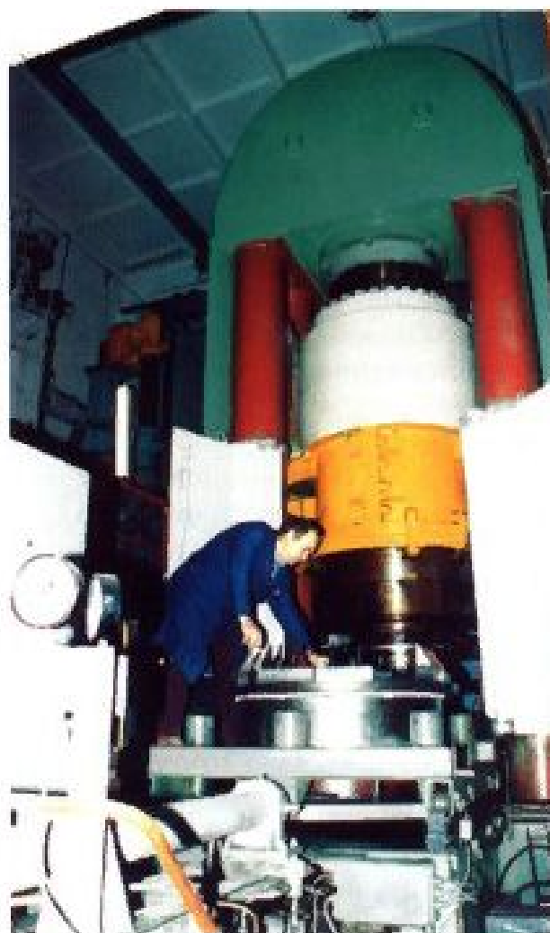
Пресс двойного действия усилием 3000 тонн, позволяющий прессовать плоские заготовки зеркал из карбида кремния диаметром до 1-го метра
