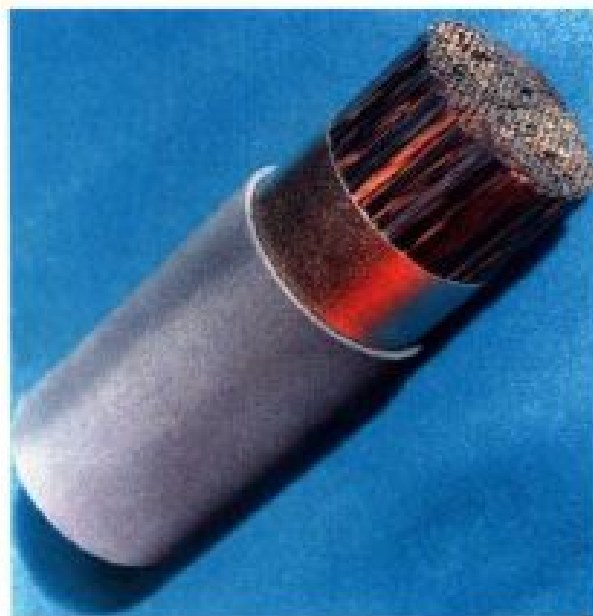
Нагревная секция ТВС реактора ИВГ-1, состоящая из центрального пучка витых твэлов и многослойной теплоизоляции
