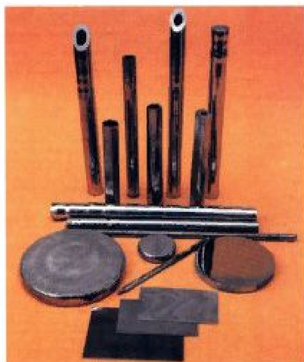
Образцы полуфабрикатов (заготовок) монокристаллов молибдена, вольфрама, ниобия получаемых по технологиям НИИ НПО «Луч»
