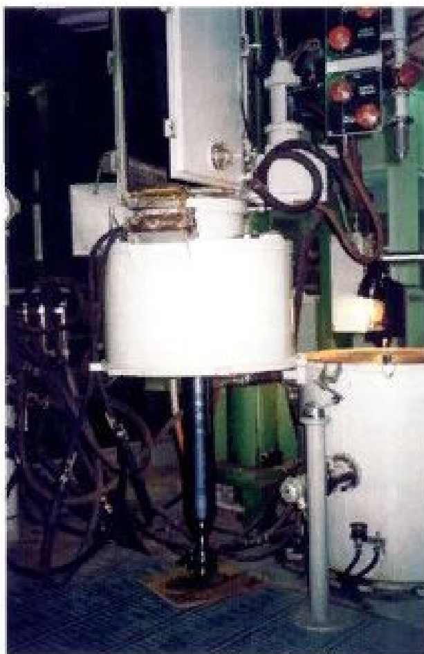
Ростовая печь с вращающимся слитком монокристалла кремния
