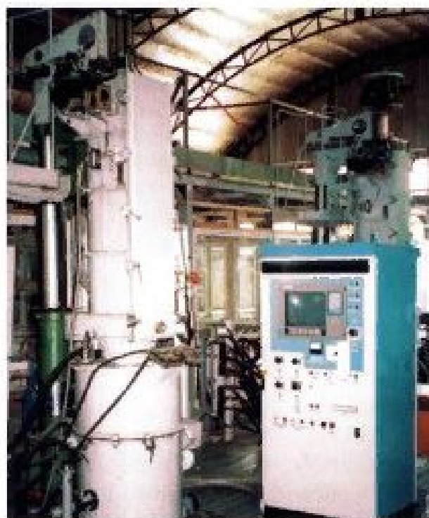
Производственный участок по выращиванию монокристаллического кремния
