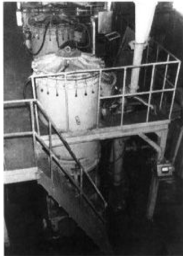
Установки горячего прессования (ГПВ-4) с усилием прессования до 200 тонн и рабочим пространством — 900 × 1800 мм
