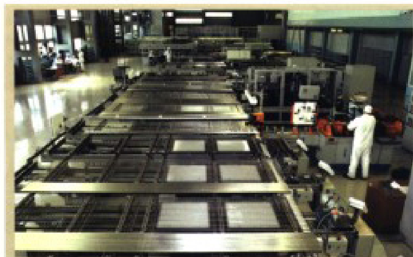
Поточная линия по производству твэлов на Машиностроительном заводе (г. Электросталь)
