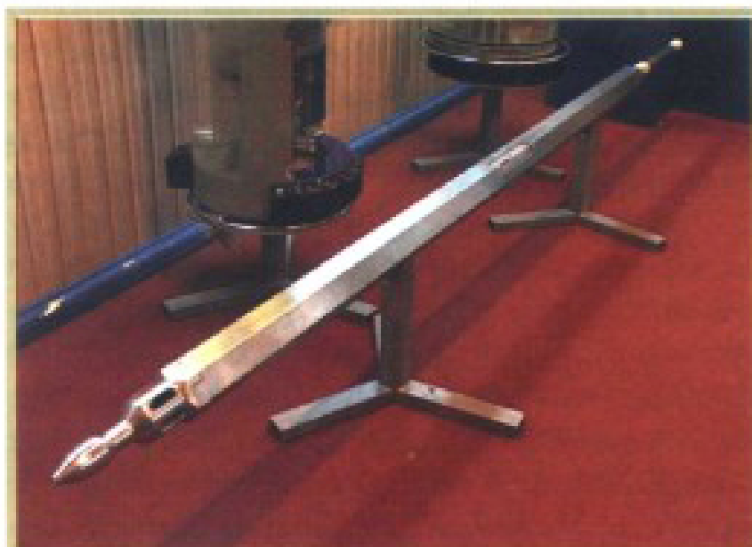
ТВЭЛ для реактора БН-600 (Белоярская АЭС)
