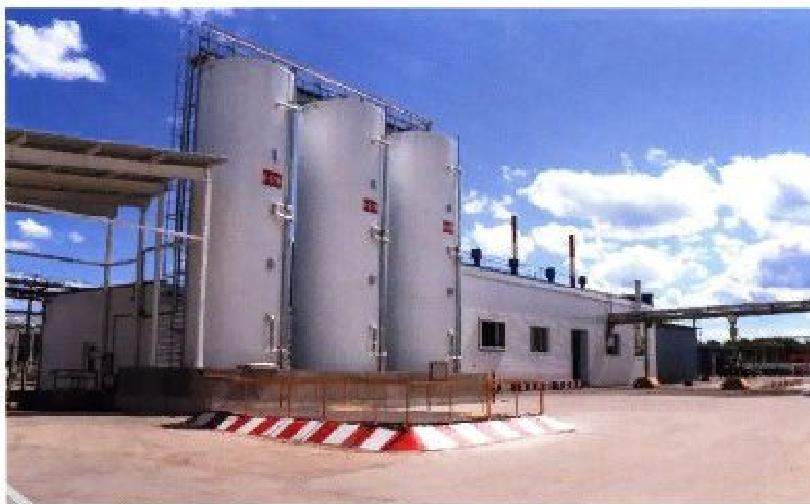
В 2020 г. реализован новый проект по установке трёх ёмкостей по 100 куб. м для приёма и хранения наливных грузов
