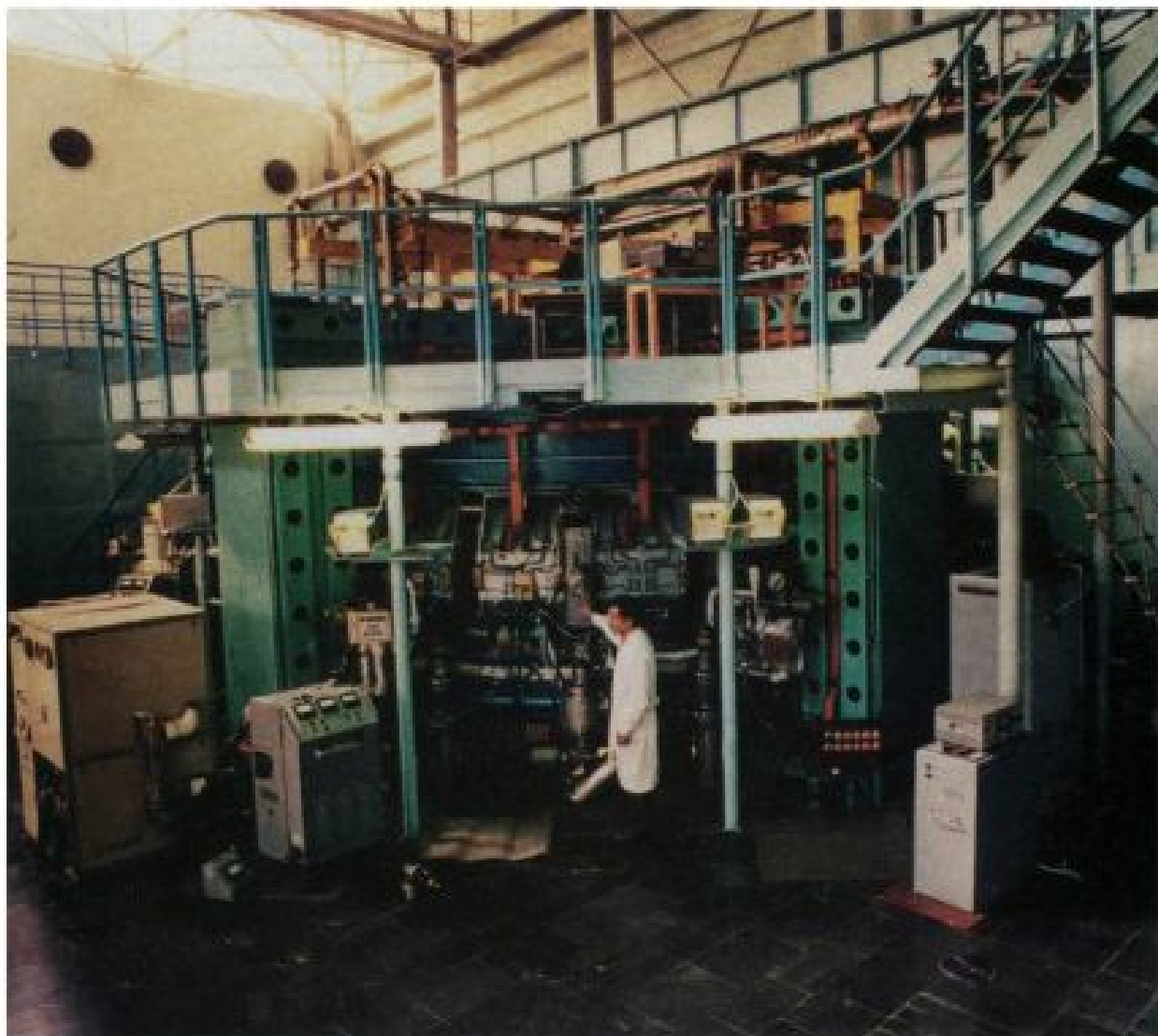
Установка «Токамак-10», на которой была получена плазма с температурой электронов 10 млн. градусов и плотностью 6 \cdot 10^{13} част./см 3 . Установка создана в ИАЭ им. Курчатова в 1975 г.
