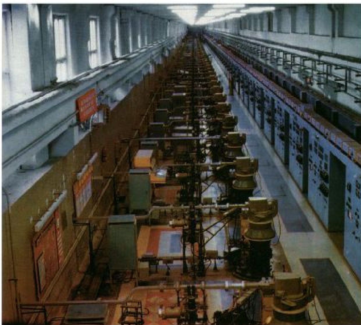
Линейный ускоритель электронов с энергией 2 ГэВ. Первые в СССР линейные ускорители электронов были разработаны в НИИЭФА в конце 50-х годов и предназначались для проведения физических исследований.
