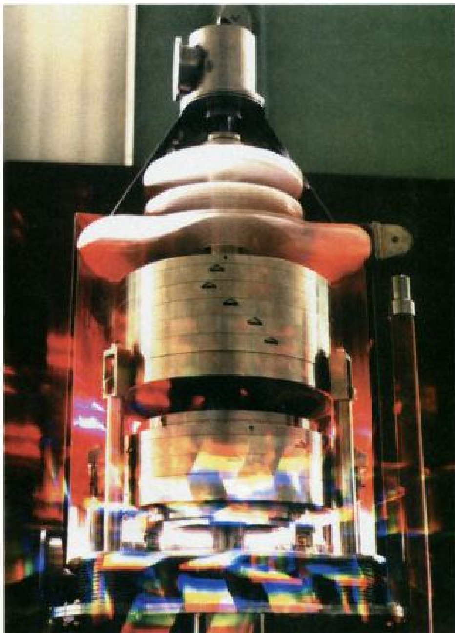
Исследовательский реактор на быстрых нейтронах – БИГР. Предназначен для изучения воздействий нейтронов на различные материалы и приборы. Разработка ВНИИЗФ, 1975 г.
