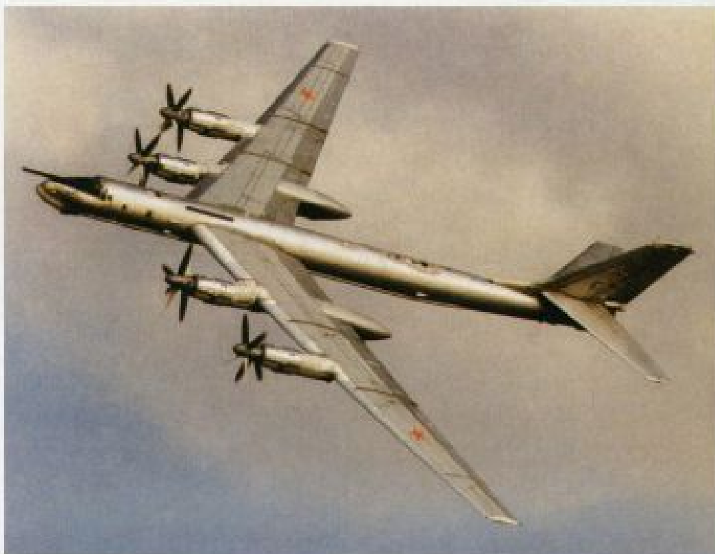
Тяжелый стратегический ракетоносец ТУ-95 МС. Имеет межконтинентальную дальность действия и вооружен шестью атомными крылатыми ракетами, размещенными в грузовом отсеке фюзеляжа.
