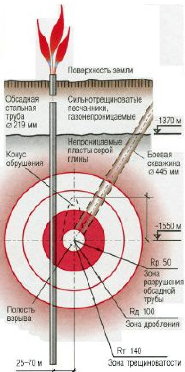
Схема тушения газового фонтана
