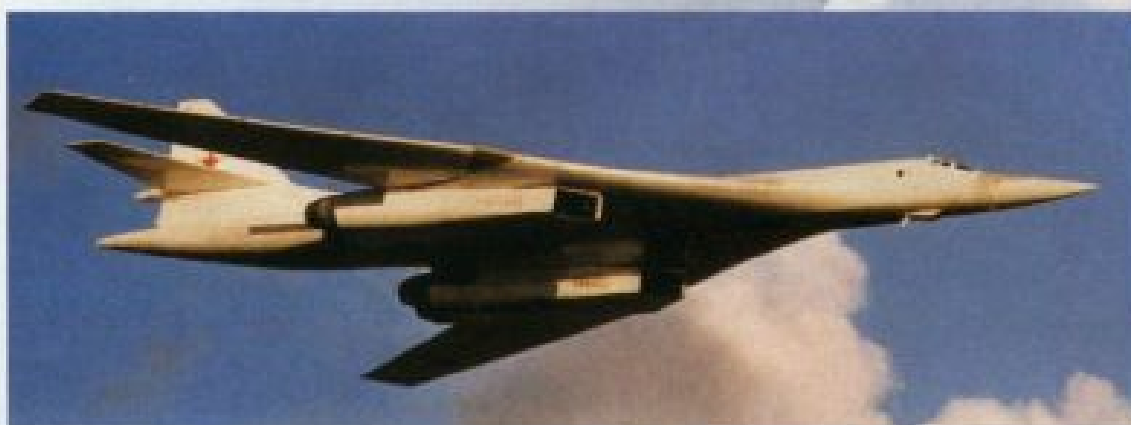
Тяжелый стратегический ракетоносец ТУ-160 (самый мощный авиационный комплекс, вооружение ракетоносца – крылатые ракеты с атомными зарядами)
