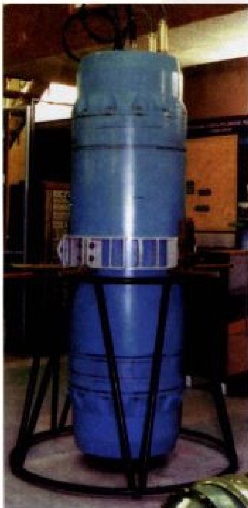
Установка с атомным зарядом для ликвидации пожаров в скважинах диаметром 720 мм на глубинах до 550 м
