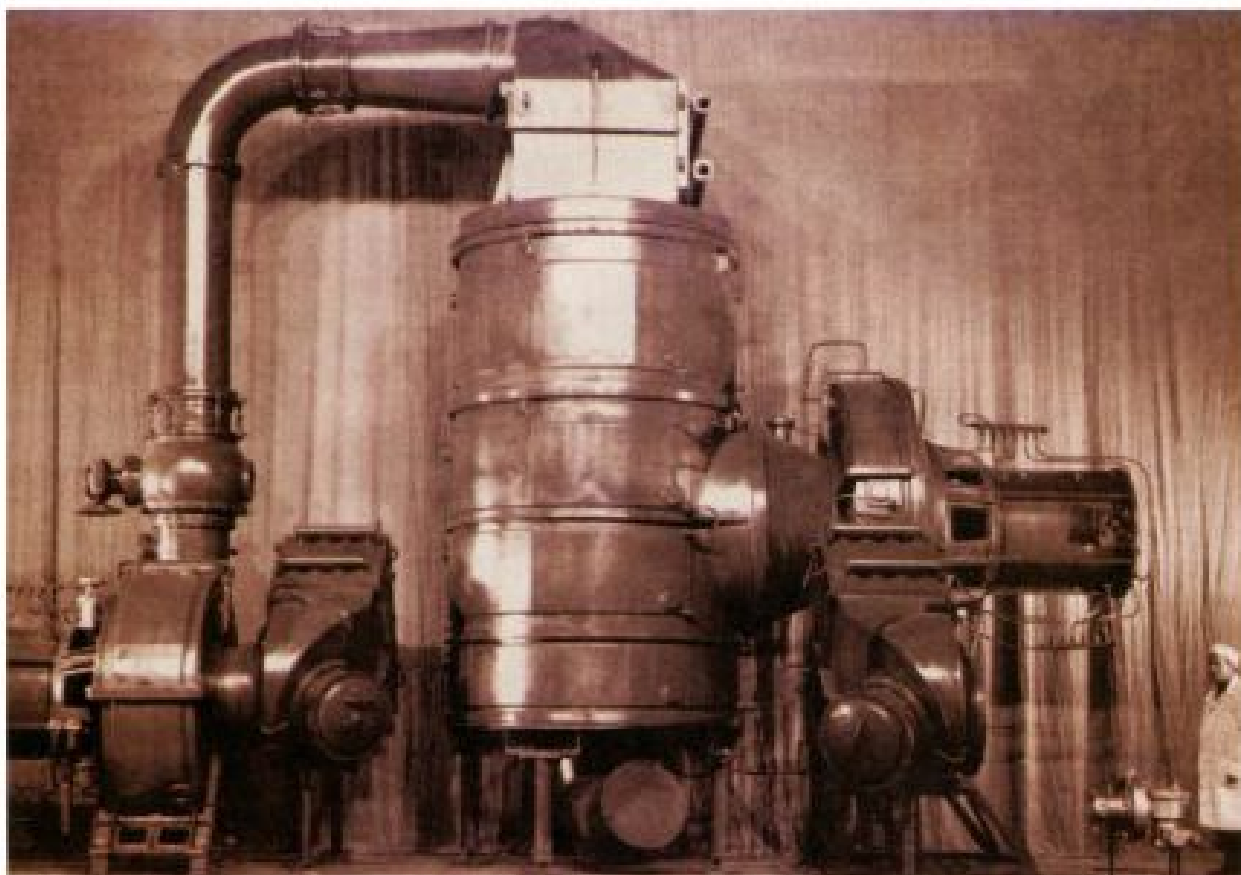
Фрагмент диффузионного оборудования для получения обогащенного урана-235
