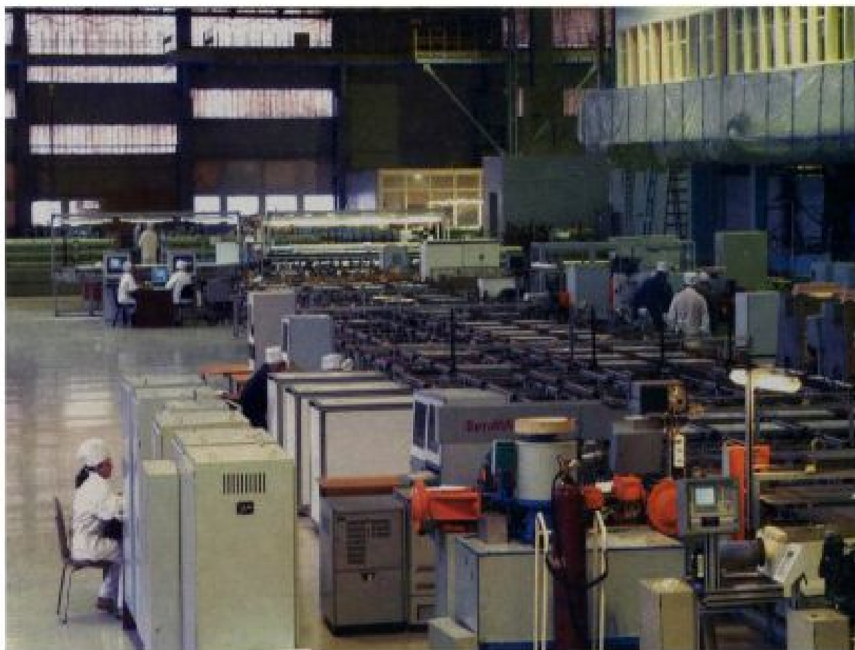
Линия В-407 по изготовлению ТВЭЛов на машиностроительном заводе в городе Электростали
