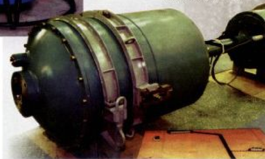
Установка с атомным зарядом для ликвидации пожаров в скважинах диаметром 920 мм на глубинах до 1000 м
