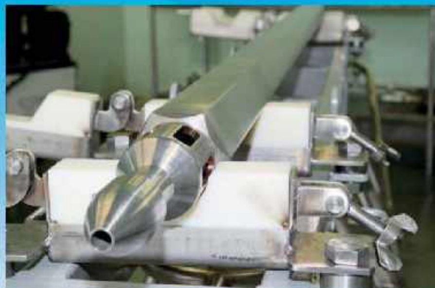
Три года эта сборка будет проходить испытание в реакторе Белоярской атомной станции
