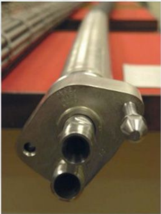
Детали тепловыделяющих элементов для первой в мире АЭС, изготовленные на заводе № 12, 1954 г.
