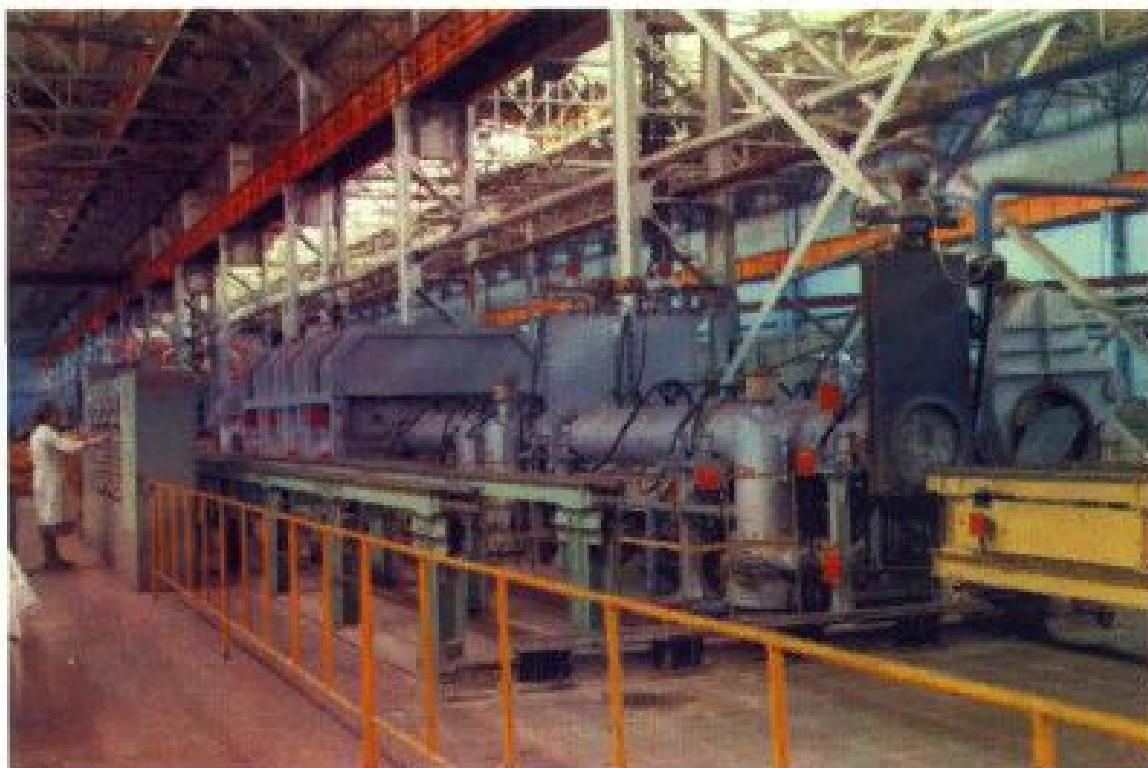
Горизонтальная вакуумная шлюзовая электропечь для непрерывной термической обработки труб из сплавов циркония.
