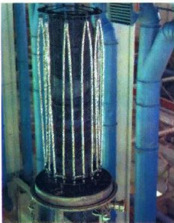
Внутренняя часть вакуумной реторты с рафинированным цирконием после окончания процесса йодидного рафинирования.
