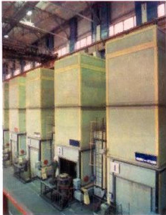
Вакуумні електродугові печі для плавки слитків цирконієвих сплавів.
