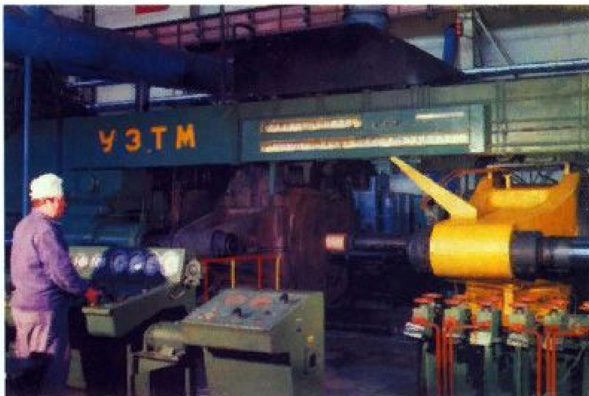
Пресс гидравлический горизонтальный с усилием прессования до 7000 тонн.
