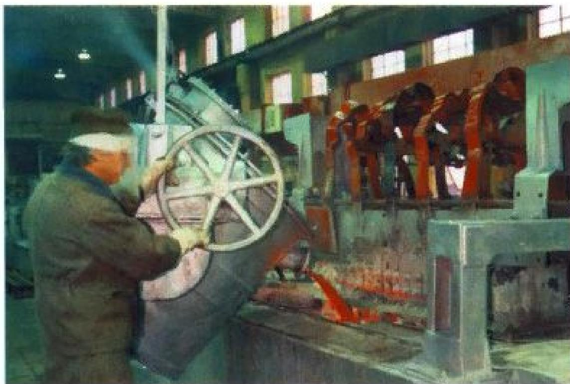
Слив медно-кальциевого сплава в ванну для электролиза при получении металлического кальция.
