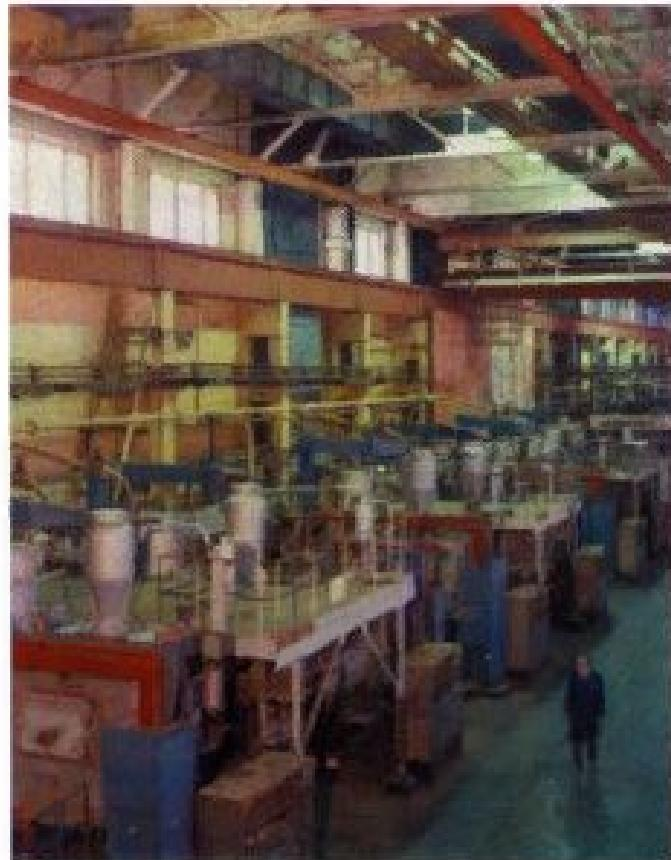
Герметичные электролизеры для получения металлического циркония.
