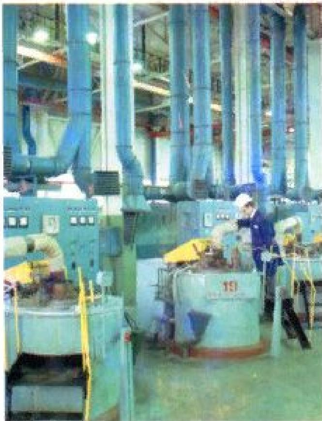
Печи для вакуумного юодидного рафініровання цирконія.
