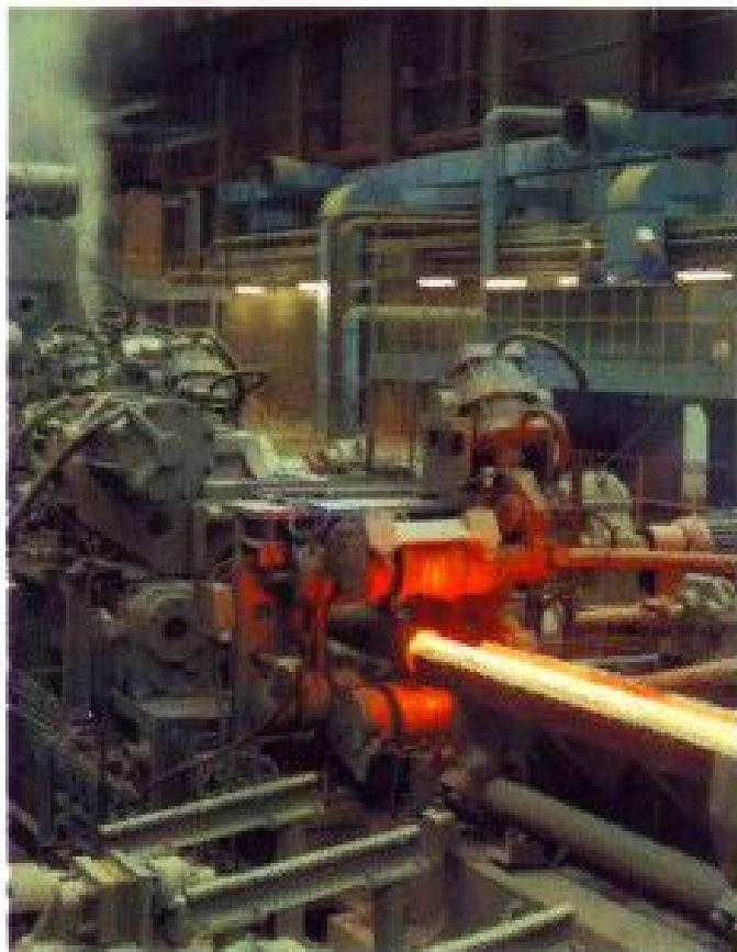
Стан горячей поперечно-винтовой прокатки слитков циркония и его сплавов.
