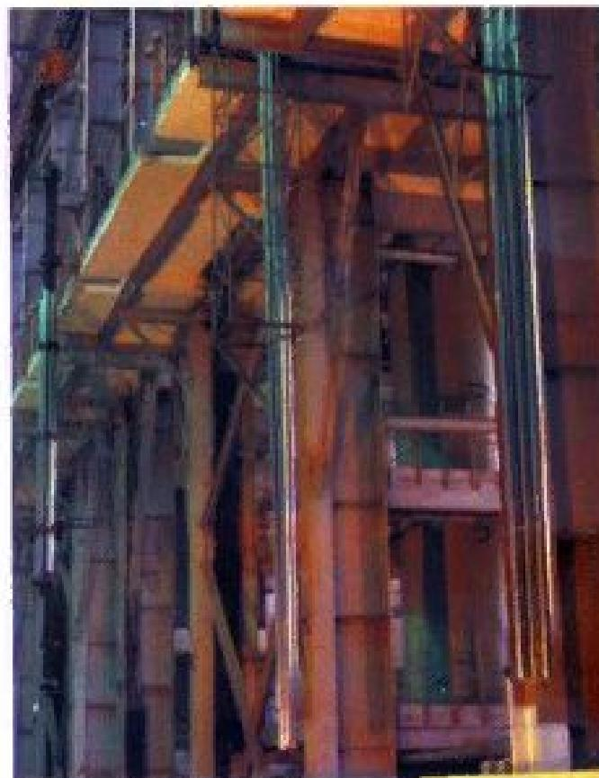
Печи вертикальные вакуумные для термической обработки труб из сплавов циркония.
