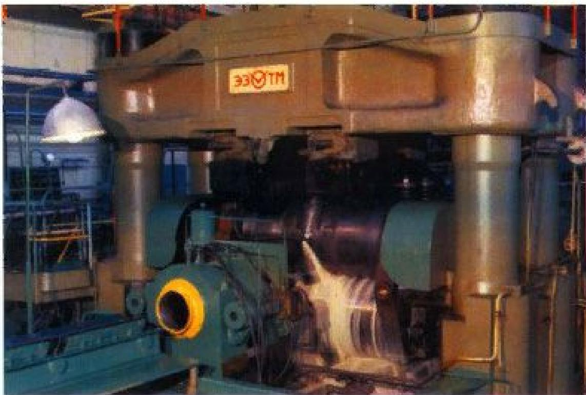
Стан для холодной прокатки труб из сплавов циркония.
