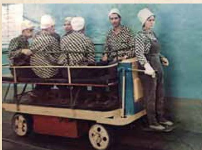
Специально оборудованная электротележка позволяла быстро доставлять к месту работы комплексные бригады
