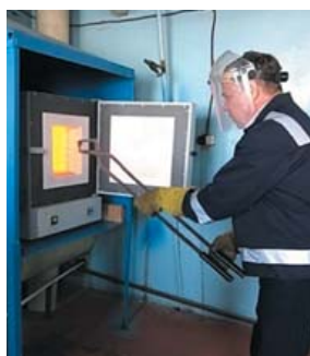
Лабораторная выплавка золото-серебряного сплава (Доре) из отходов производства серно-кислотного завода (пиритных огарков) ПАО «ППГХО»
