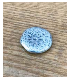
Лабораторная выплавка золото-серебряного сплава (Доре) из отходов производства серно-кислотного завода (пиритных огарков) ПАО «ППГХО»
