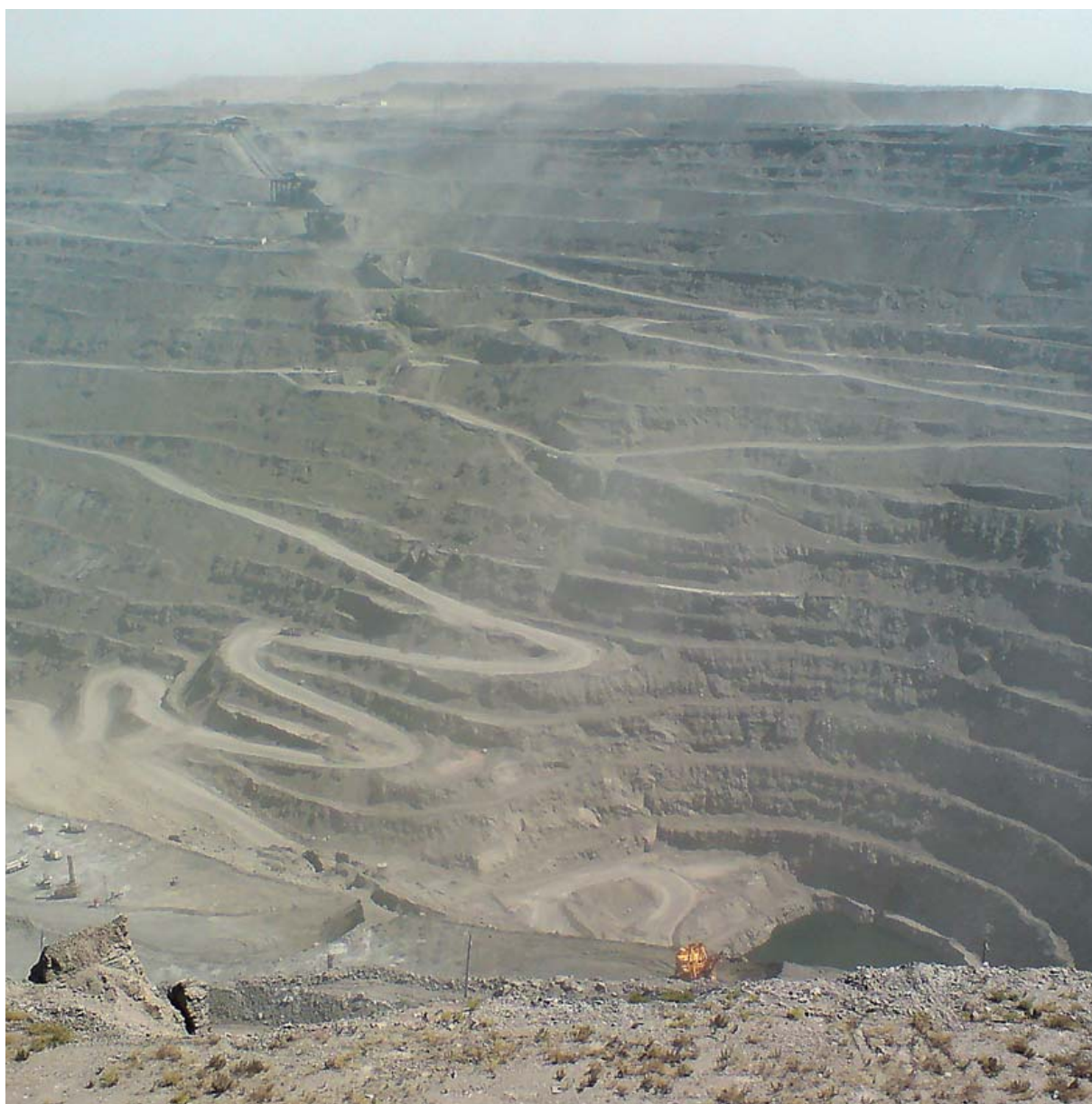
Крупнейший в мире карьер по добыче золотосодержащих руд Мурунтау. Разработка месторождения ведется с применением буровзрывной технологии
