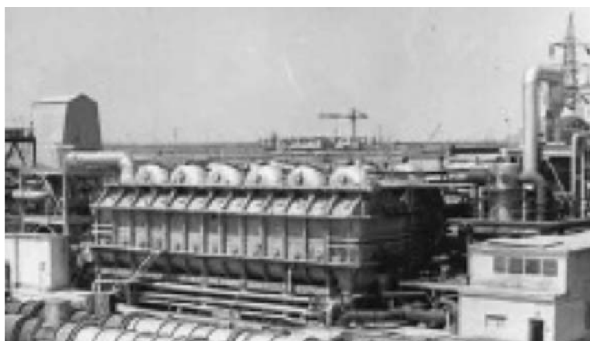
Рис. 5. Установка мгновенного вскипания
