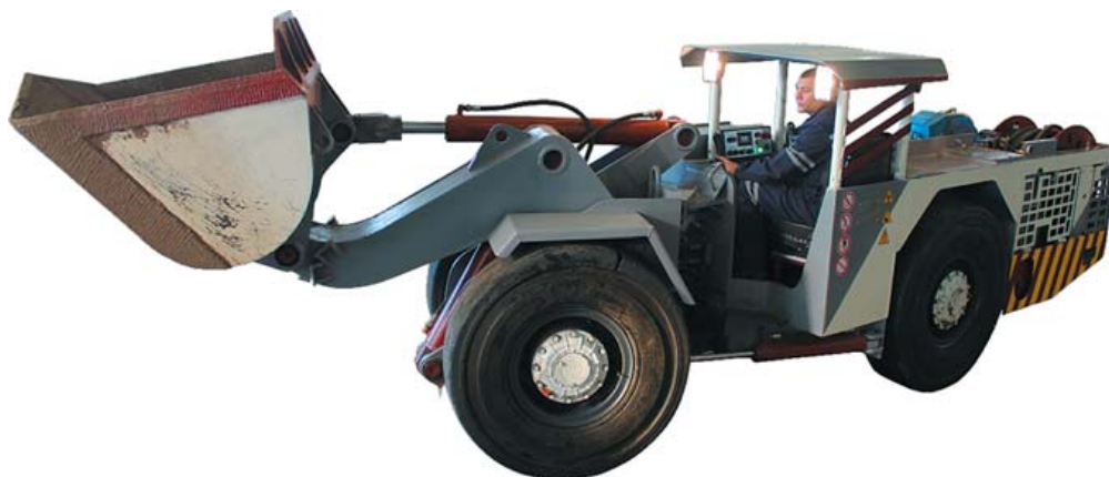
Погрузочно-доставочная машина ПД-2ЭЭ
