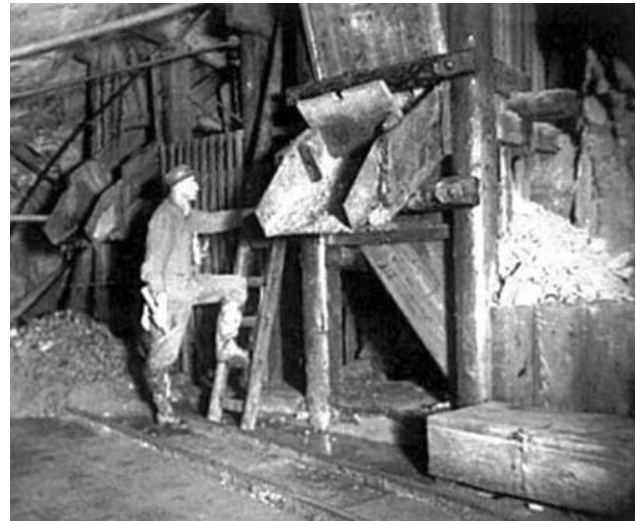
Рудник Вайсер Хирш. Загрузочное устройство в вагонетке у ствола Кронпиц Альбрехт
