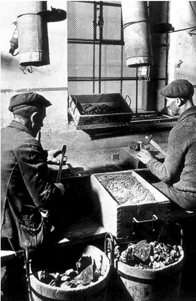
Ручная рудосортировка урановой руды на Яхимовских рудниках 1945–1946 гг. Черная урановая смолка складывалась в рудничный ящик для дальнейшего извлечения урана
