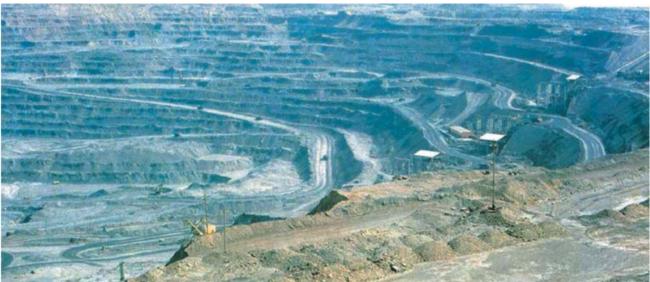
Крупнейший в мире карьер по добыче золотосодержащих руд Мурунтау. Разработка месторождения ведется с применением буровзрывной технологии
