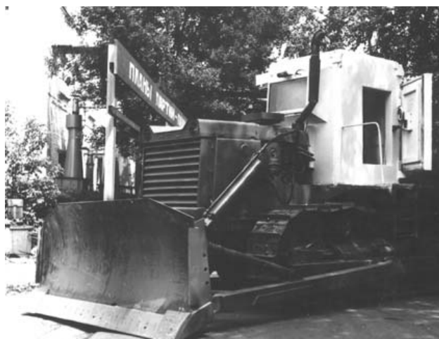
Бульдозер, оснащенный биозащитной кабиной
