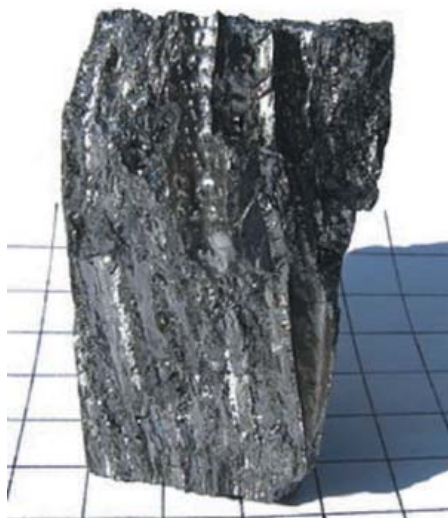
Относительно твердый, хрупкий металл светло-серого цвета бериллий, чистота >99%, поликристаллический фрагмент
