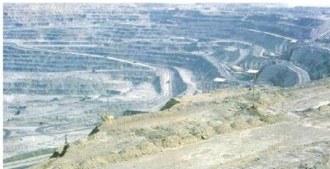
Крупнейший в мире карьер по добыче золотосодержащих руд Мурунтау Разработка месторождения ведется с применением буровзрывной технологии
