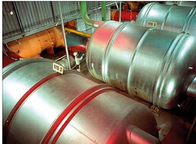
Газодиффузионное оборудование завода K-25 в Ок-Ридже
