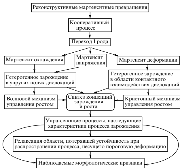
Рис. 14. Узловые моменты описания мартенситной реакции в моно- и поликристаллических материалах с размерами зёрен, превышающими критический размер D_c .
