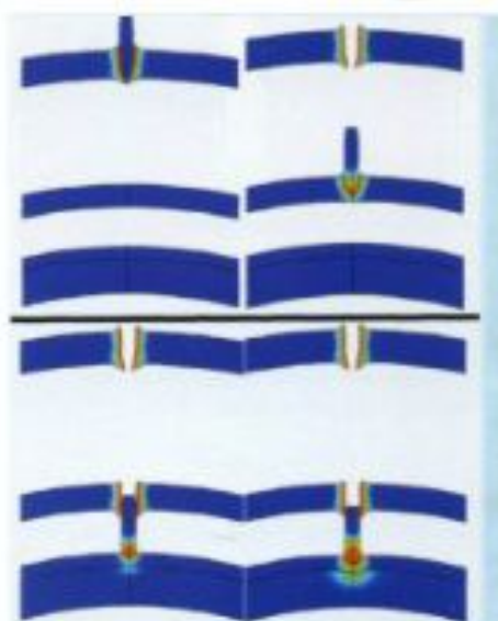
Положение составной преграды и ударника на различные моменты времени
