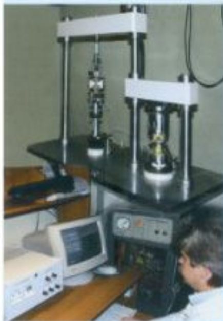
Автоматизированная установка ИПРМ-50К для испытания ВВ на растяжение, сжатие, изгиб, работавшая в режиме ручного и программного управления
