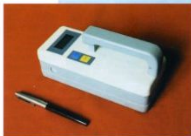
Носимый радиационный монитор БИРК-3
