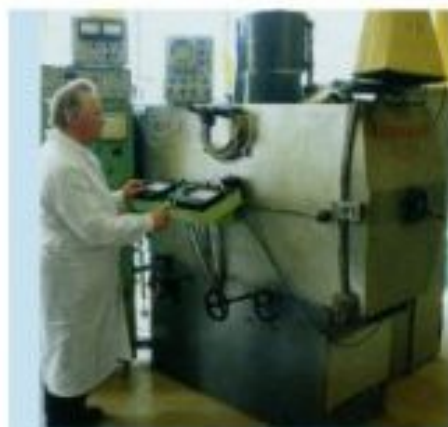
Установка электронно-лучевой сварки ЭЛУ-5
