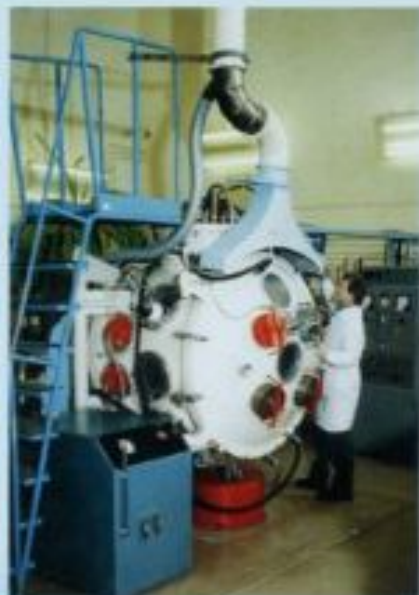
Установка плазменного напыления в защитной среде и динамическом вакууме
