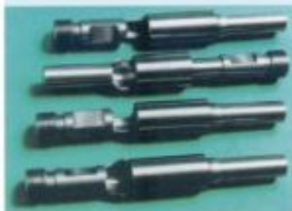
Общий вид разрушенных после испытаний макетов термомеханического соединения трубопроводов диаметром 12 мм, изготовленных из нержавеющей стали 12Х18Н10Т. Средняя несущая способность соединения муфтами из никелида титана составила 200 МПа при коэффициенте вариации 10 %
