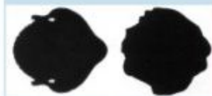
Расчетная форма (слева) и экспериментальная рентгенограмма (справа) поражающего элемента СФБЧ
