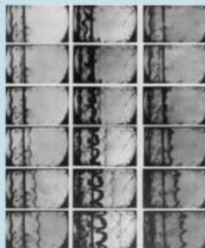
Хронограммы первых экспериментов на ударной трубе по исследованию неустойчивости, индуцированной ударной волной
