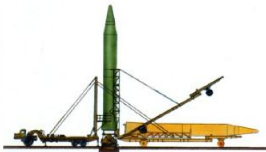
Схема установки ракеты Р-14 на ПУ
