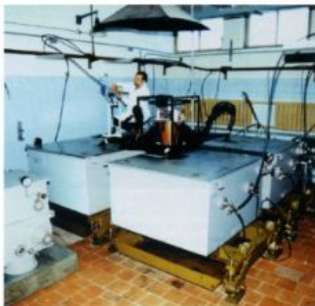
Стенд для электродинамического ударного нагружения
