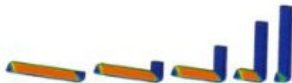
Заготовка на различных этапах РКУП (компьютерное моделирование)
