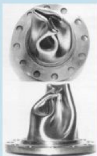
Автозатвор до и после срабатывания
