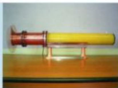
Генератор VMG-100 со встроенным взрывным размыкателем токового контура, обеспечивающий в нагрузке 20 нГн ток более 3 МА, нарастающий за 300 нс
