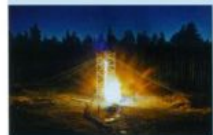
Интегральная картина работы имитатора импульса молнии, использующего МКГ типа С-320, на стержневой заземлитель
