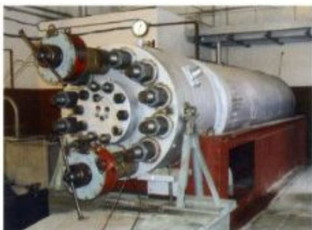
Установка для гидростатических испытаний
