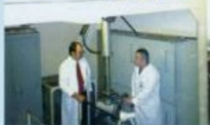
Стенд для получения микросфер
