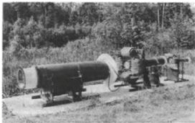
Каскадный генератор МК-2, выпущенный Ленинградским научно-производственным объединением «Электрофизика». Устройство состоит из трех генераторов с трансформаторной связью между собой; каждый предыдущий генератор служит источником энергии для последующего. Таким образом достигается высокий коэффициент усиления энергии ( 10^3 ) и эффективное преобразование энергии взрыва (до 10 %). Выходная энергия генератора — 1,3 \cdot 10^7 Дж.
