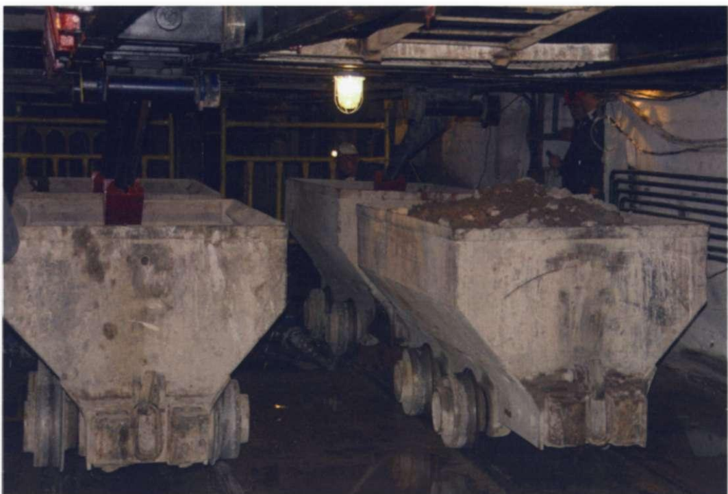
Околоствольный двор ствола 11В. Комплекс обмена вагонов
