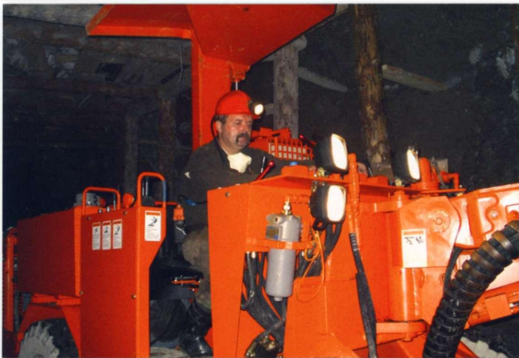
Погрузочно-доставочная машина «Microscop-100Э» (производства Финляндии)
