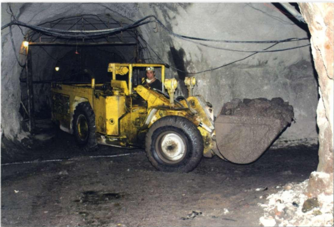
Погрузочно-доставочная машина ПД-2Э (производства РМЗ ОАО «ППГХО»)
