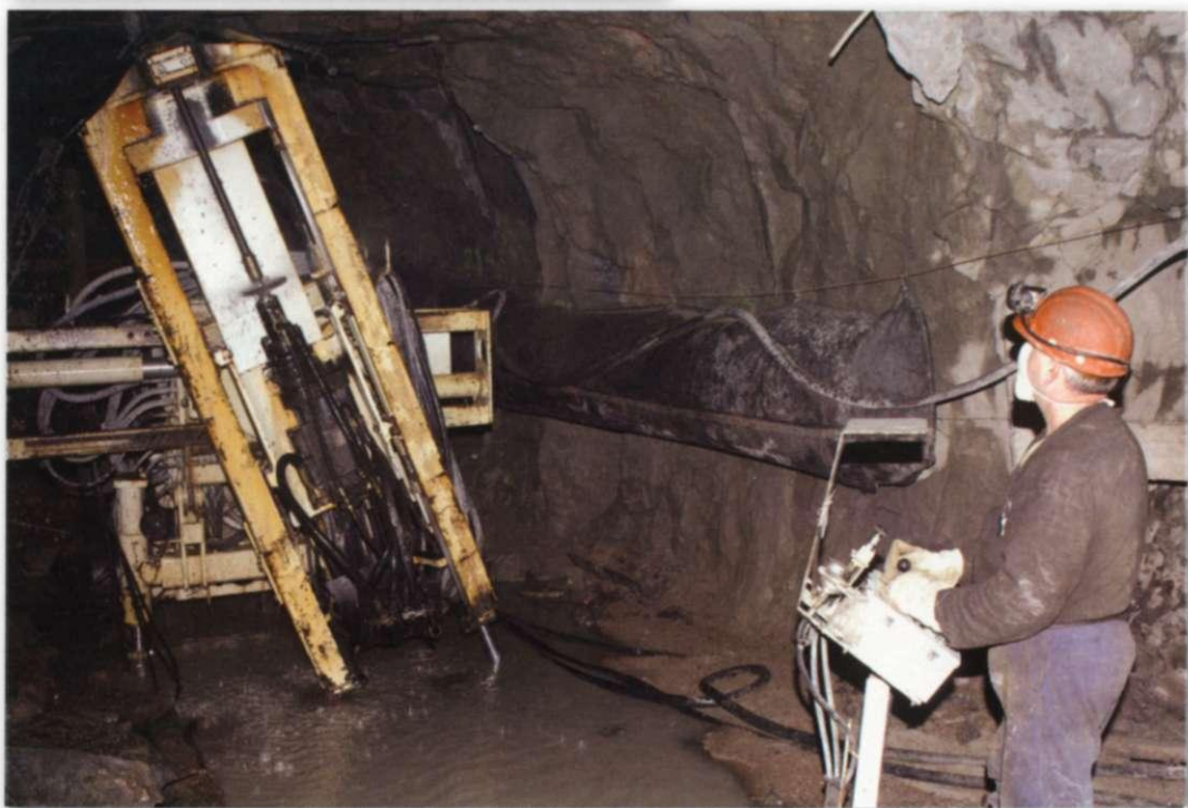
Буровая установка ПБ-100 для бурения скважин
