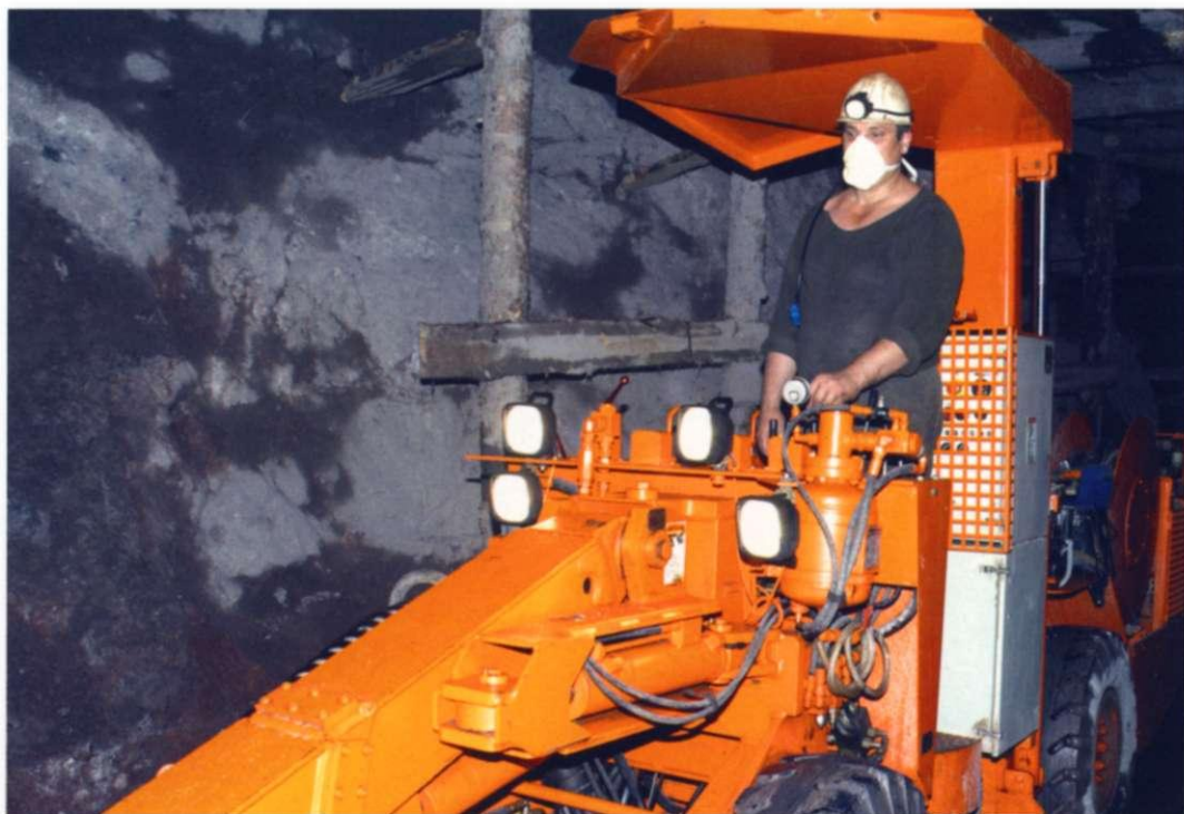
Буровая установка Minibug-1F (производства Финляндии)
