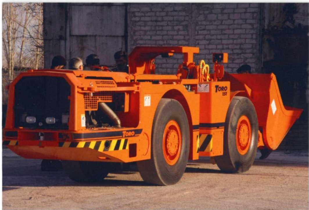
Дизельная погрузочно-доставочная машина TORO для отгрузки горной массы из очистных забоев
