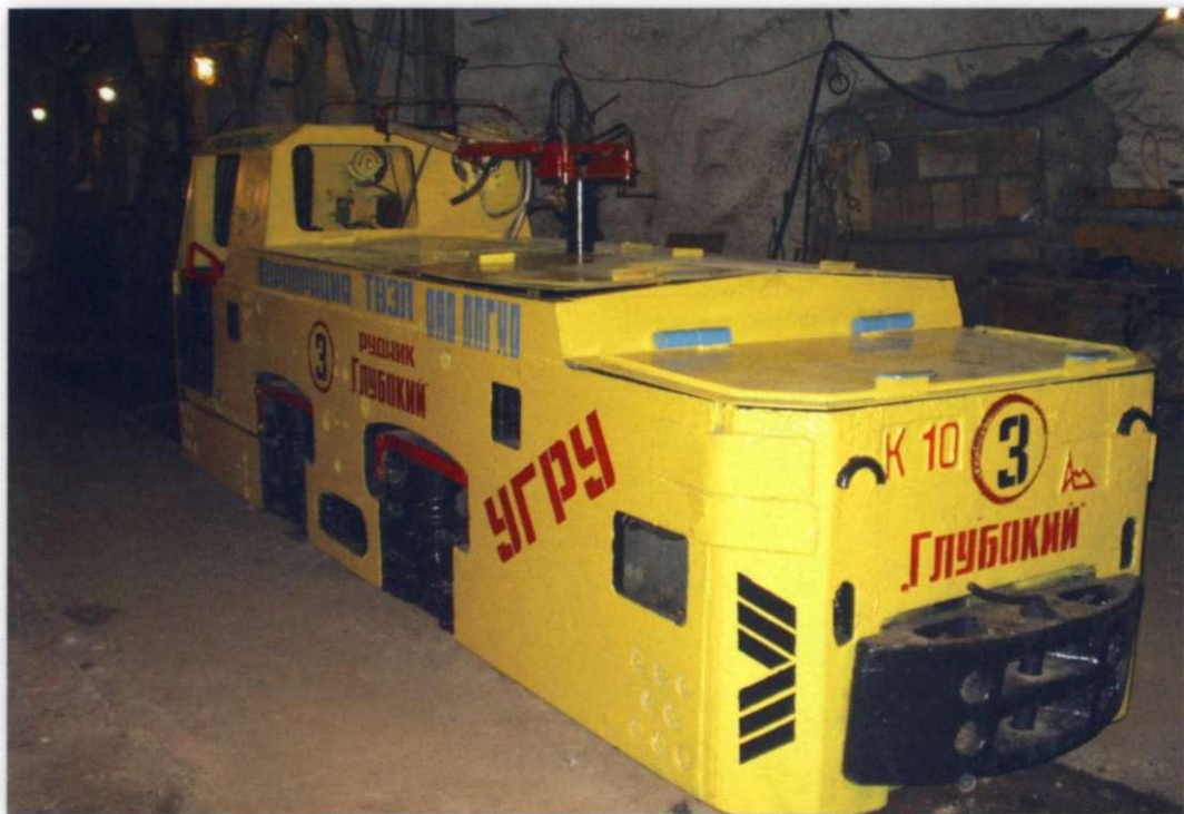
Контактный электровоз К-10 для перевозки горной массы в подземных выработках
