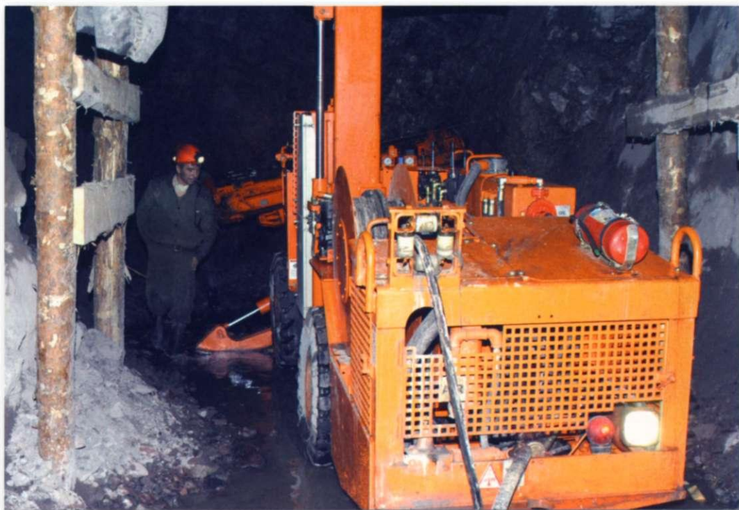
Буровая установка Minibug-1F (производства Финляндии)
