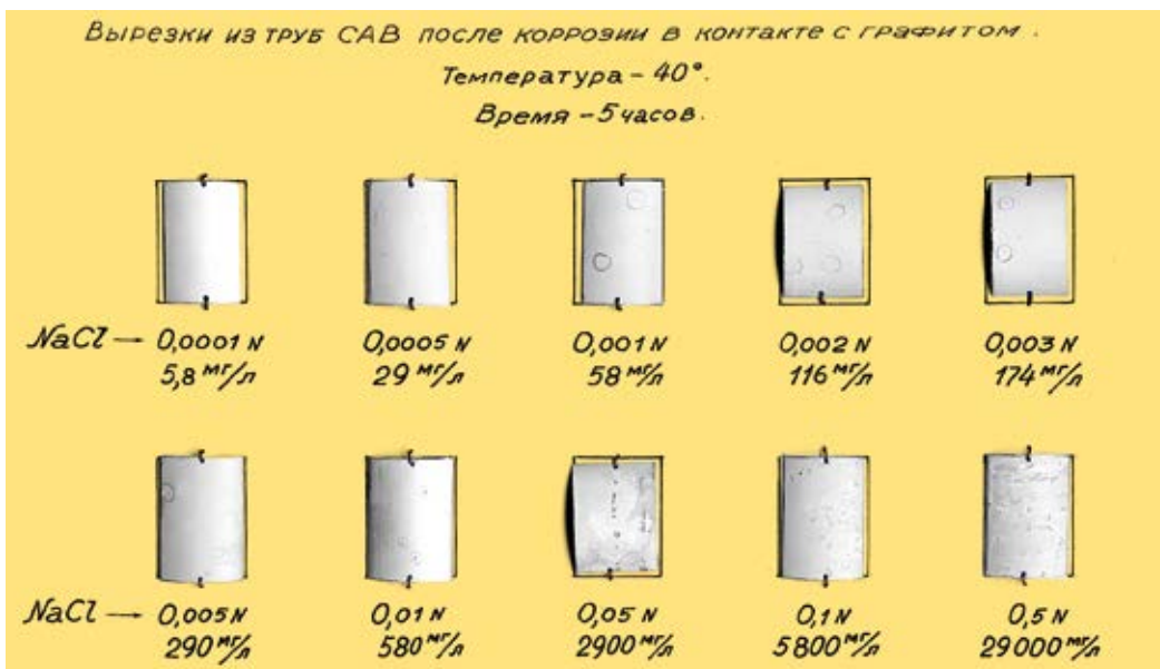
Фрагменты алюминиевых трубок, пораженных коррозией после соприкосновения с графитом в реакторе. 1948 Центратомархив. Ф. 1. Оп. 1. Ед. хр. 96. Л. 156
