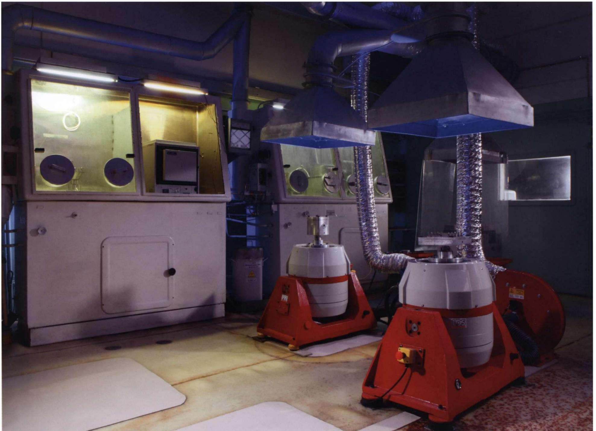
Вибростенд для проведения испытаний изделий
