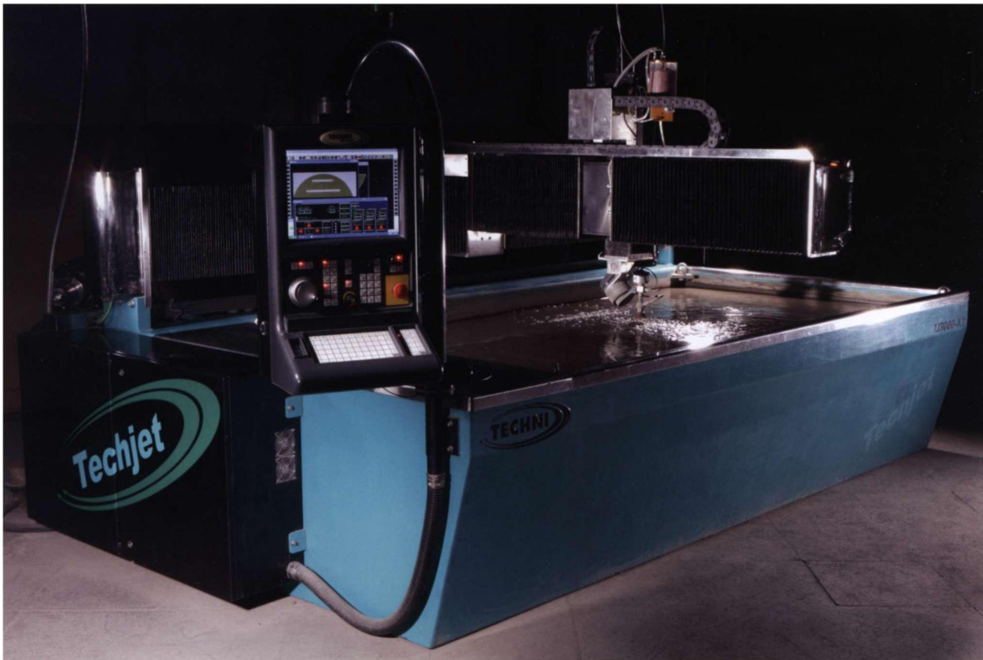
Станок гидроабразивной резки
