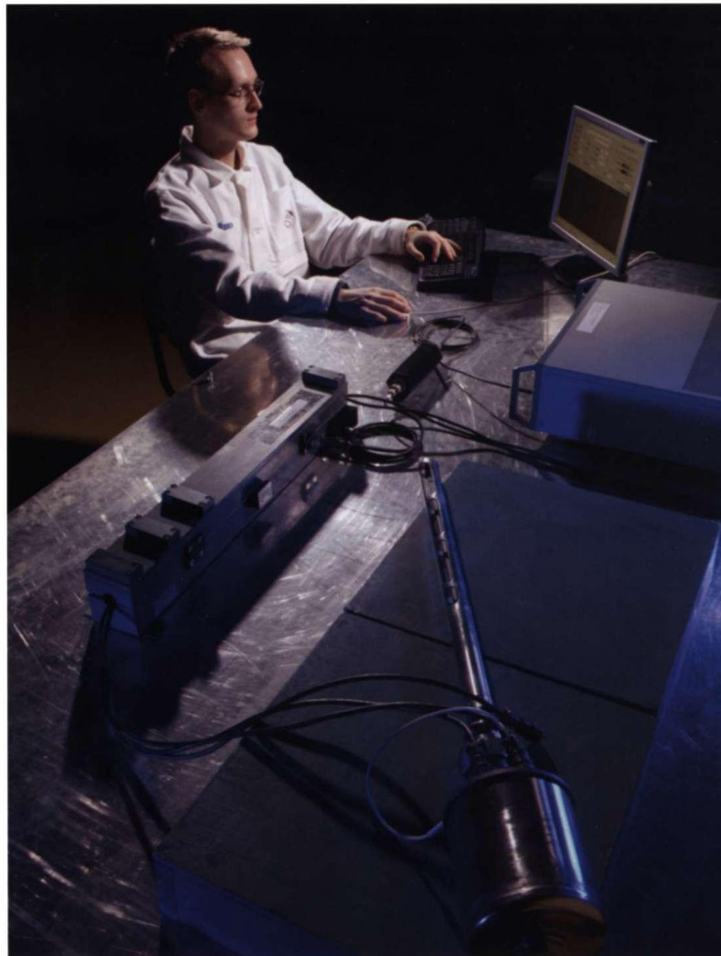
Испытания уровнемера УВВ-М на соответствие требованиям
