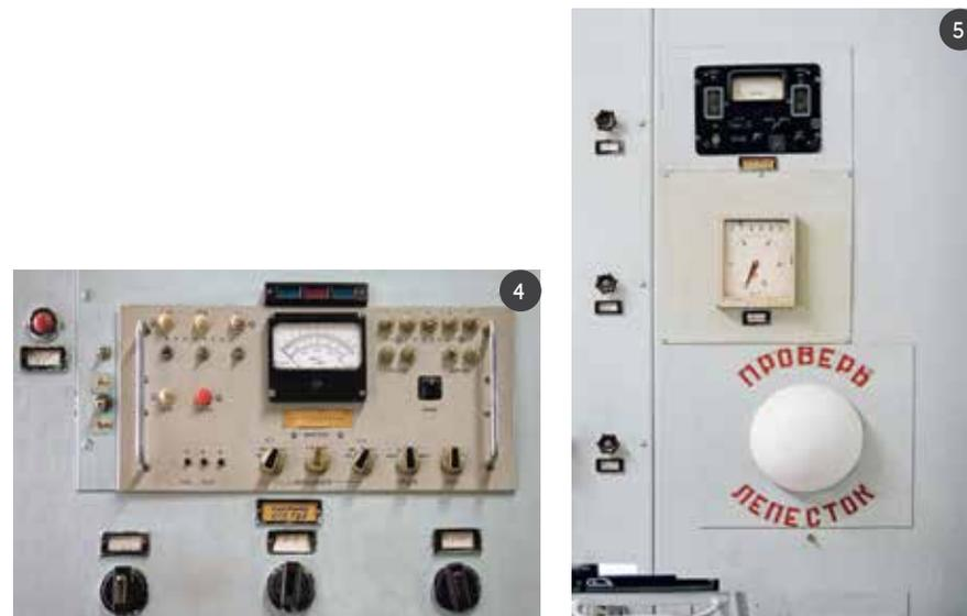
7 Щит «И». Приборы для измерения герметичности оболочек ТВЭЛ
