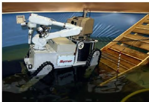
*Преодоление водной преграды глубиной до 0,5 метра ПА РТК-Р.*
