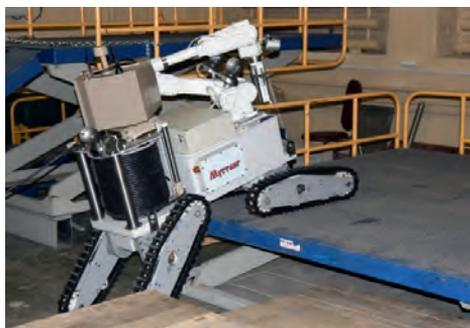
*Преодоление эскарпа высотой до 0,5 метра ПА РТК-Р*
