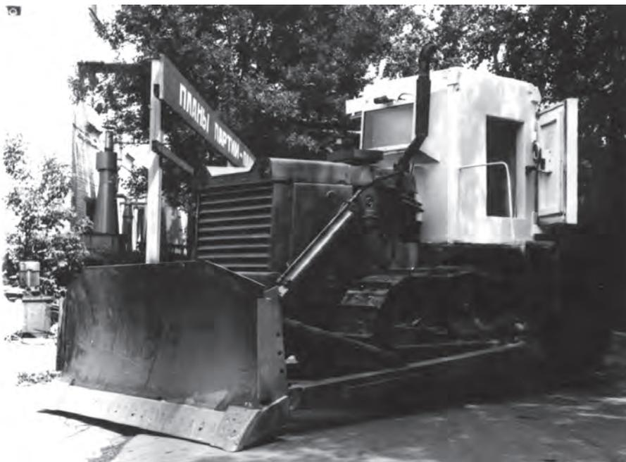
*Бульдозер, оснащенный биозащитной кабиной*
