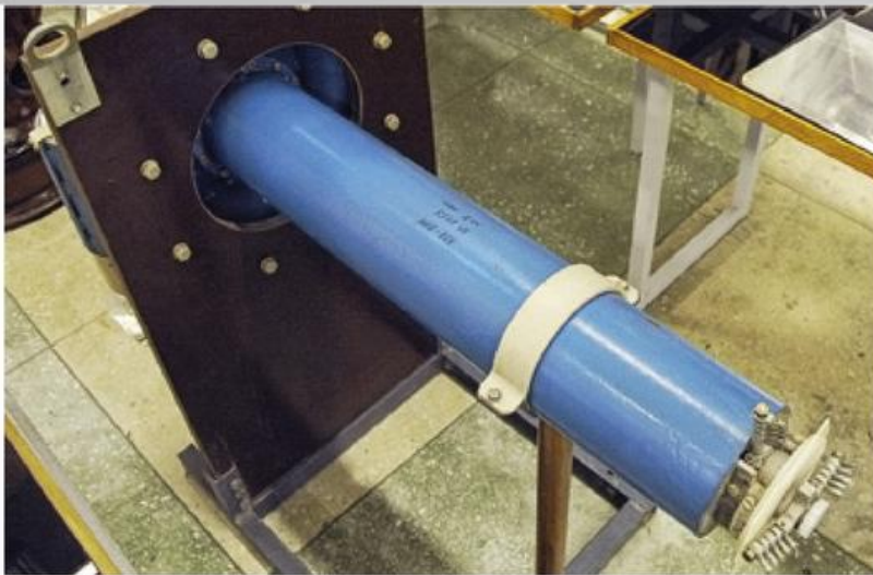
Взрывомагнитный генератор ВМГ-80
