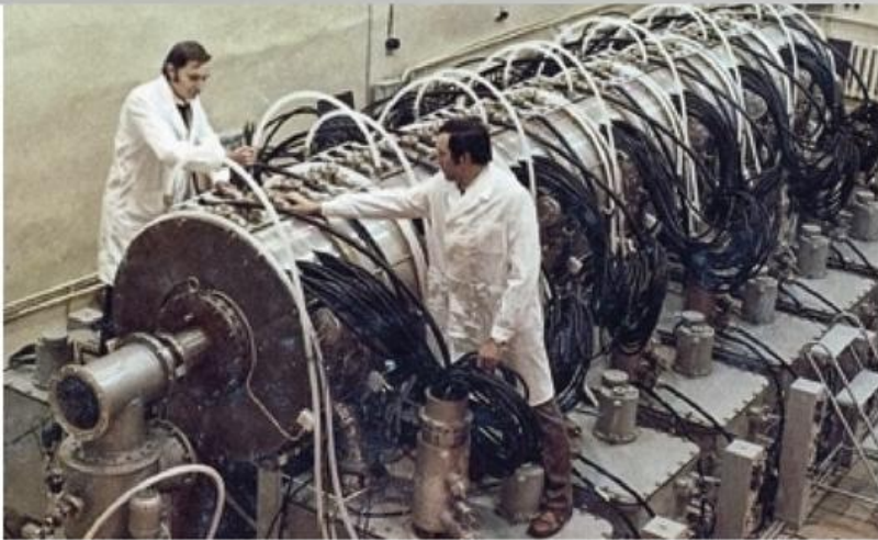
Линейный индукционный ускоритель электронов ЛИУ-10
