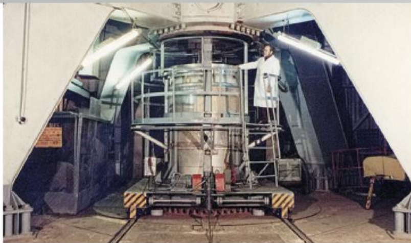
Пневмогидравлическая ударная установка ПУ-1600
