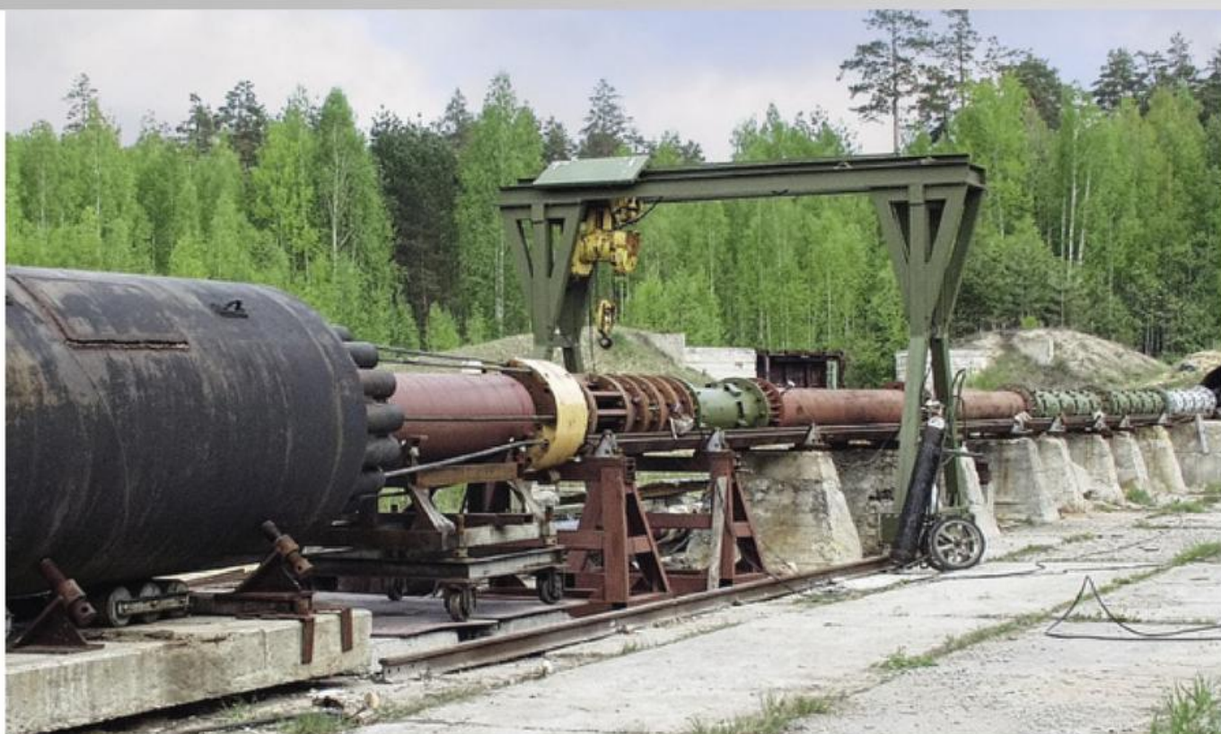
Взрывной ударный стенд «Ствол-410М»
