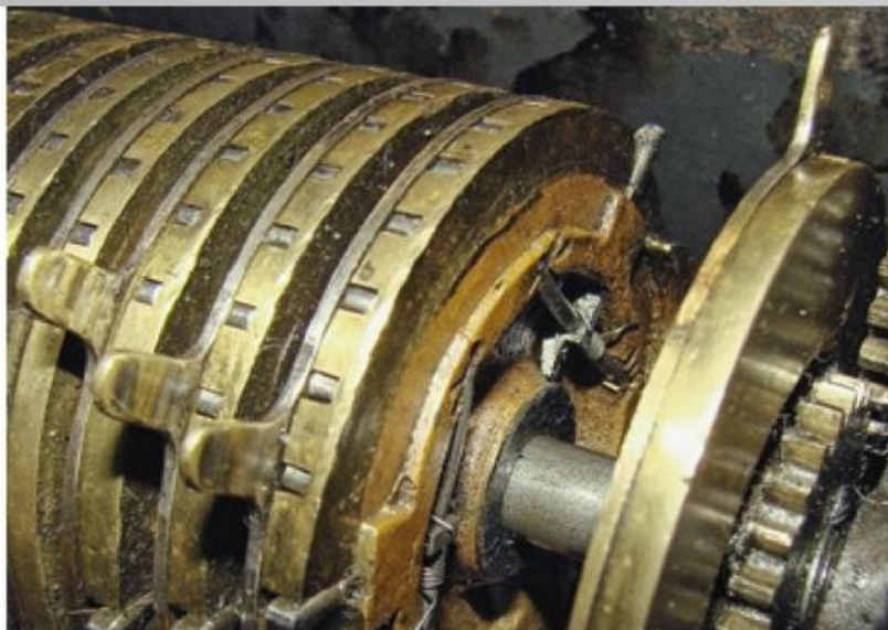
Счетный зубчатый барабан арифмометра
