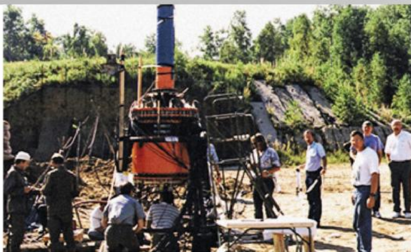
Подготовка к рекордному опыту «HEL-1» ВНИИЭФ – LANL с ДВМГ диаметром 1000 мм
