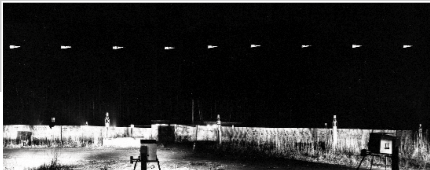
Фиксация стадий движения объекта испытаний по траектории его полета
