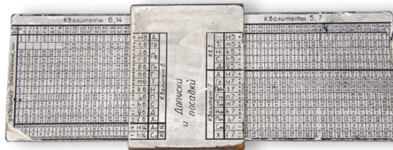
Линейка-конструктор (из числа счетных линеек специального назначения). Использовалась на заводе «Авангард» (ВНИИЭФ) для простановки допусков размеров деталей; изготовлена сотрудниками завода. Из фондов Музея ядерного оружия. Передано В.И. Ткачёвым
