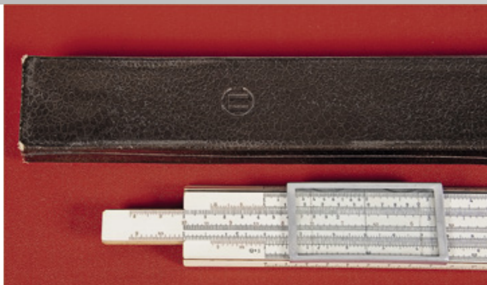
Большая логарифмическая линейка, фрагмент. Размеры (д×ш×в) – 580×40×10 мм; длина шкалы – 500 мм
