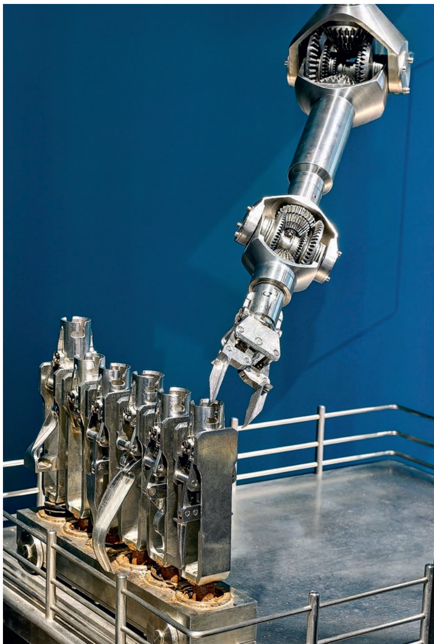
Манипулятор МЭМ-10СДГ. Разработчик — НПО манипуляторной техники и тонкой механики ФГУП «ГНЦ РФ ИФВЭ» (производство — ПО «Балтиец», Нарва, начало 1960-х гг.). Используется по настоящее время
