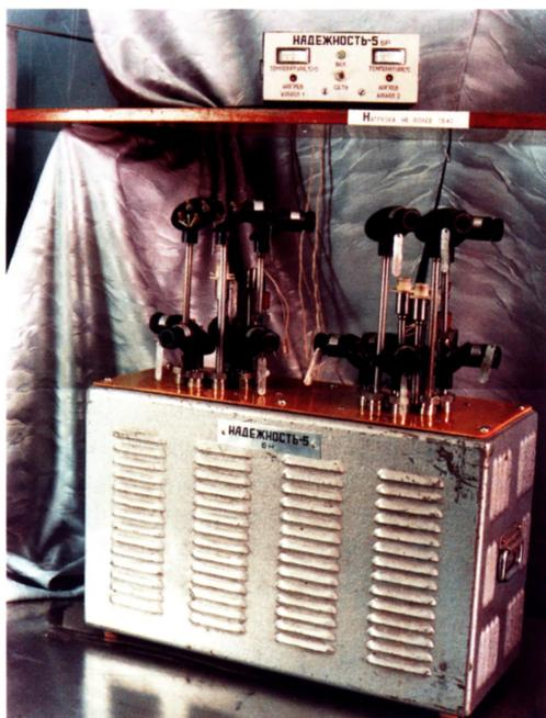
*Стенд «Параметр» для испытания твэлов, их сборок в условиях, имитирующих различные стадии проектных и запроектных аварий реакторов ВВЭР*
