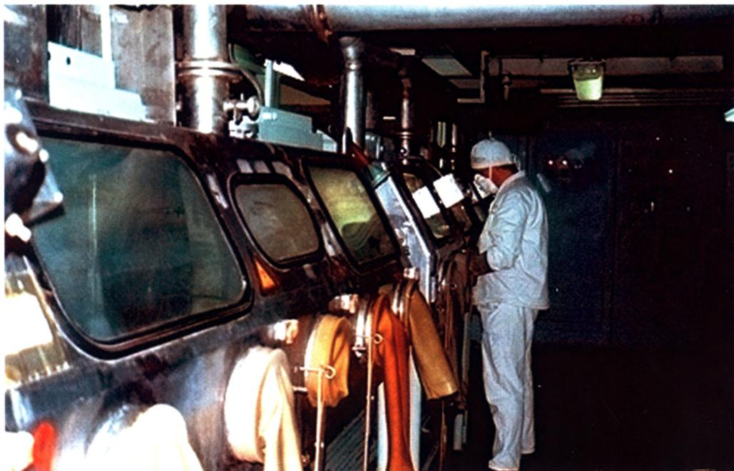
*Работа по переработке урана в перчаточных герметичных боксах*
