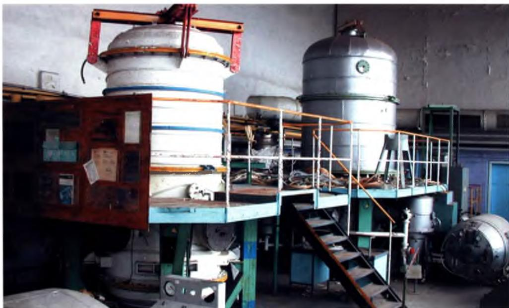
*Стенды термовакуумных испытаний агрегатов космических ядерных энергетических установок*
