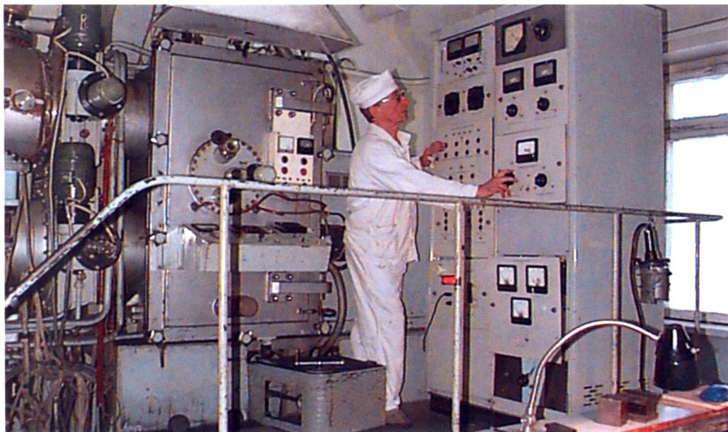
*Установка для выращивания монокристаллов молибдена и сплавов на его основе*
