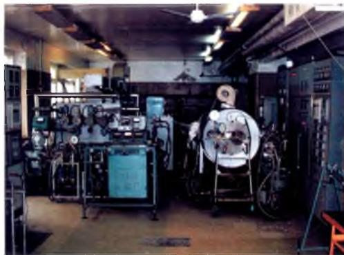
*Стенд термовакуумных испытаний
