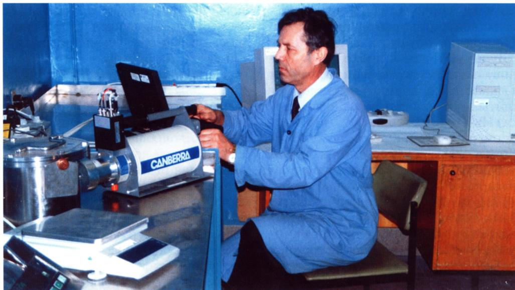
*Ответственный за измерения ЯМ в Центральном хранилище Е.К. Лысенко проводит неразрушающие измерения изотопного состава ЯМ на гамма-спектрометре фирмы Канберра*
