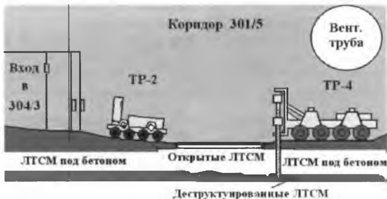
Рис. 2.42. Схема работ по исследованию ЛТСМ и бетона в коридоре 301/5 с помощью ТР-4 и ТР-2
