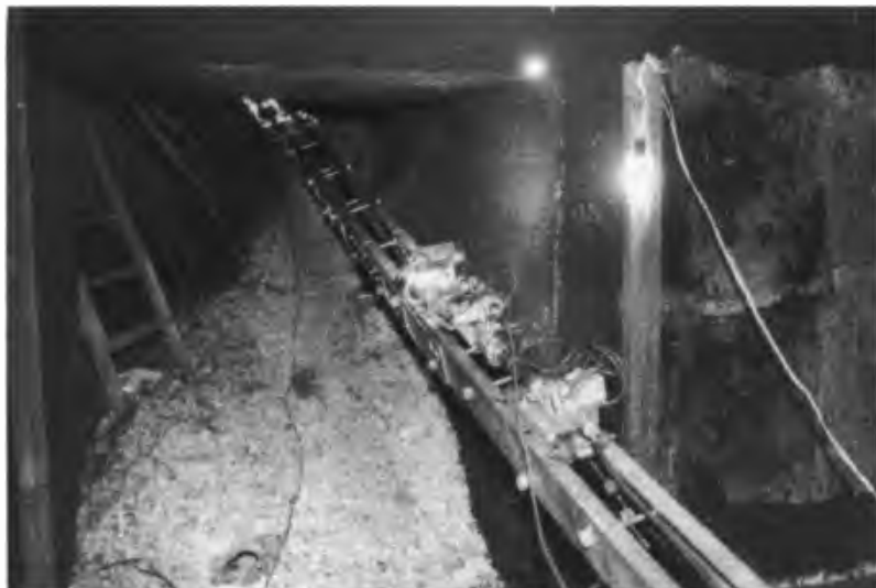
Рис. 3.20. Робот-разведчик, оснащенный телекамерой, осветительными и другими приборами, передвигаясь по специальным рельсам, проник в подаппаратное пом. 305/2
