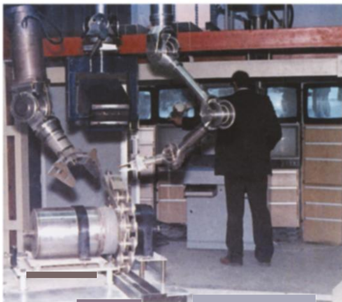
Настройка параметров манипулятора М-54
