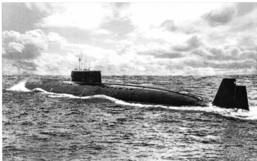
Самая скоростная подводная лодка с крылатыми ракетами ( V=44,7 узла)
