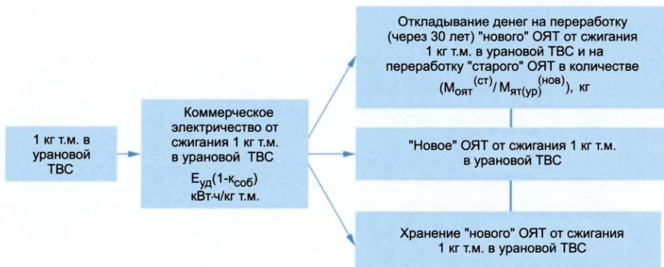
Рис. 2.5. Отсроченный замкнутый ЯТЦ с вовлечением энергетического плутония из "старого" ОЯТ
