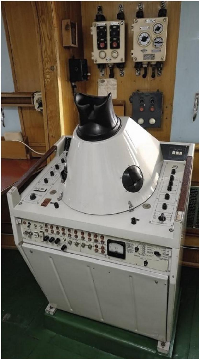
**Индикатор кругового обзора (прибор И) навигационной радиолокационной станции «Наяда-5»**
