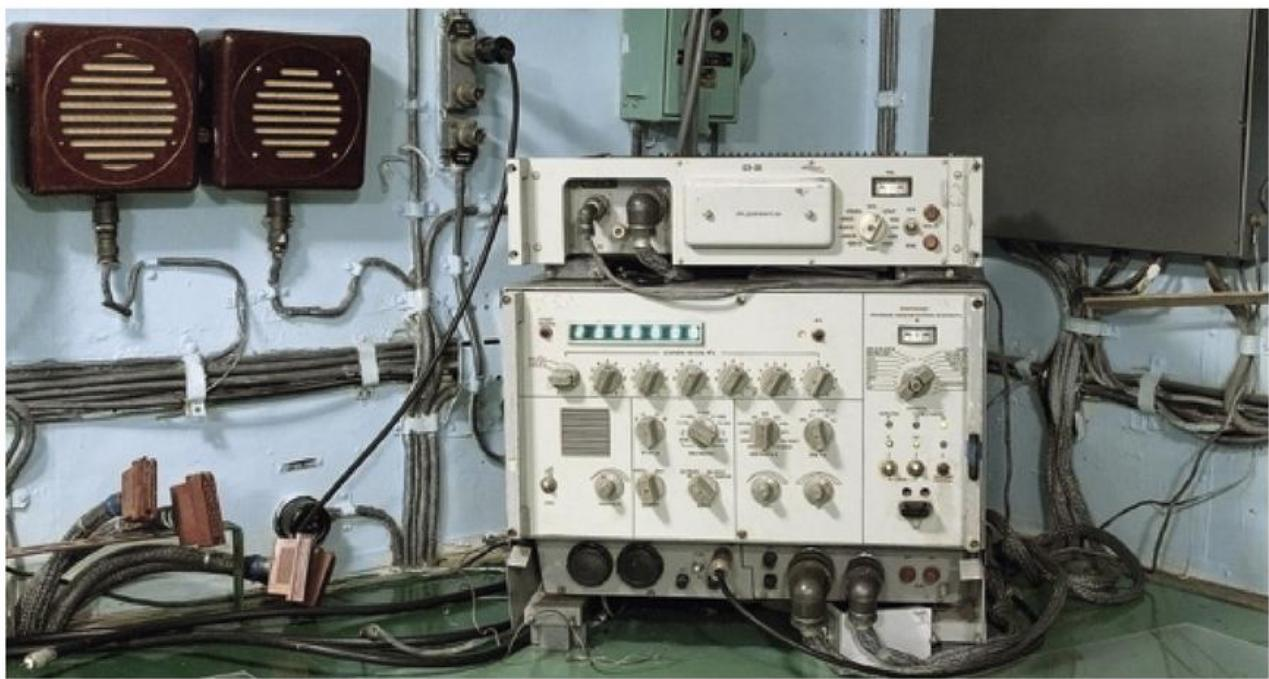
Радиоприемное устройство «Циклоида»
