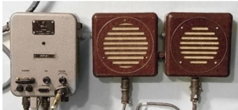
Блок формирования посылок смонтирован в сборно-штампованным корпусе из листовой стали. Крышка прибора откидывается вниз на шарнирах и является несущей конструкцией для остальных узлов, кроме размещенных в нижней части корпуса штепсельных разъемов. На лицевой панели расположены органы управления ключом: тумблер
