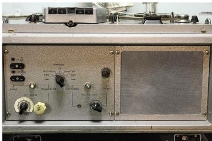
лителей и выпрямителя, вентилятор охлаждения, динамический громкоговоритель и детали электрической схемы. Передняя панель отведена для размещения пылезащитной сетки динамика, элементов управления усилителем, регуляторов уровня записи,
