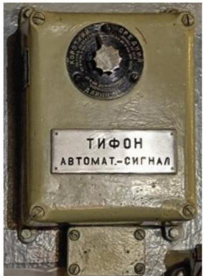
Тифон – прибор для подачи звуковых сигналов (гудков) высокой мощности в условиях ограниченной видимости
