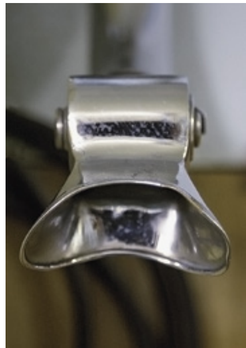
Судовая система переговорных труб Трубы стальные фосфатированные и латунные, арматура из латуни
