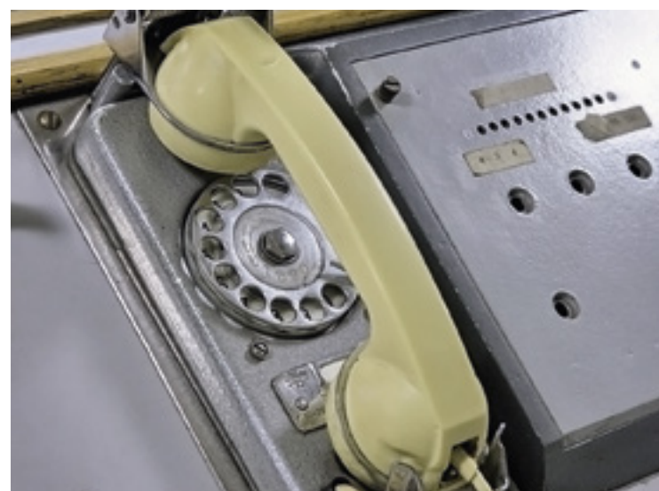
Телефон внутрисудовой связи ТАС-М – малогабаритный судовой телефонный аппарат с дисковым номеронабирателем и трубкой со штормовым креплением
