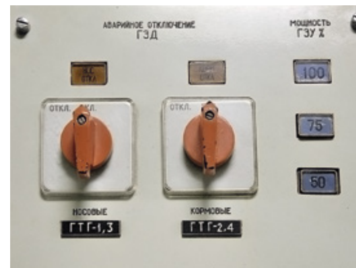
Индикаторы ограничения мощности главной энергетической установки ледокола
