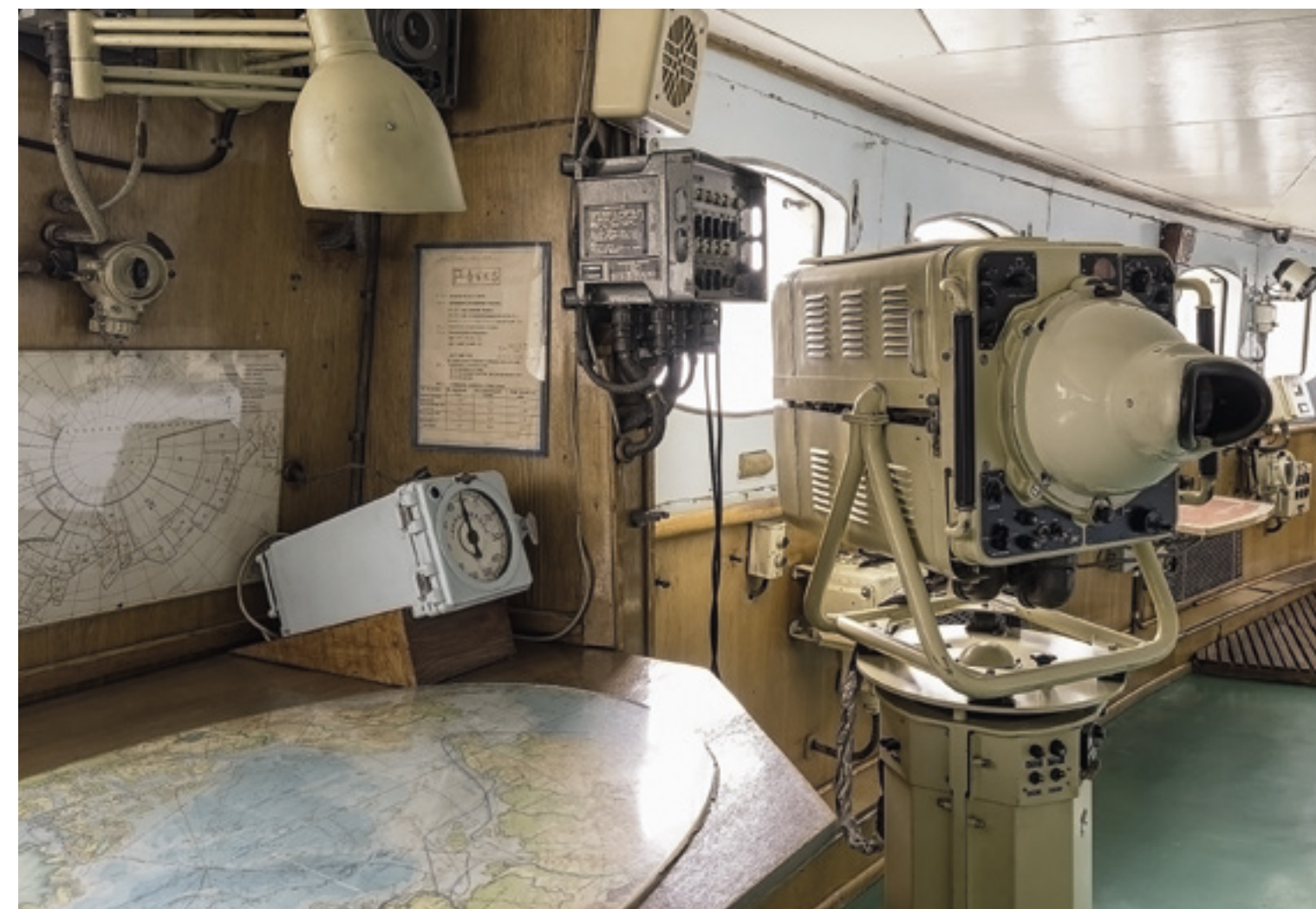
Индикатор кругового обзора (прибор И) навигационной радиолокационной станции «Дон» Предприятие п/я Г-4563, 1978 г.
