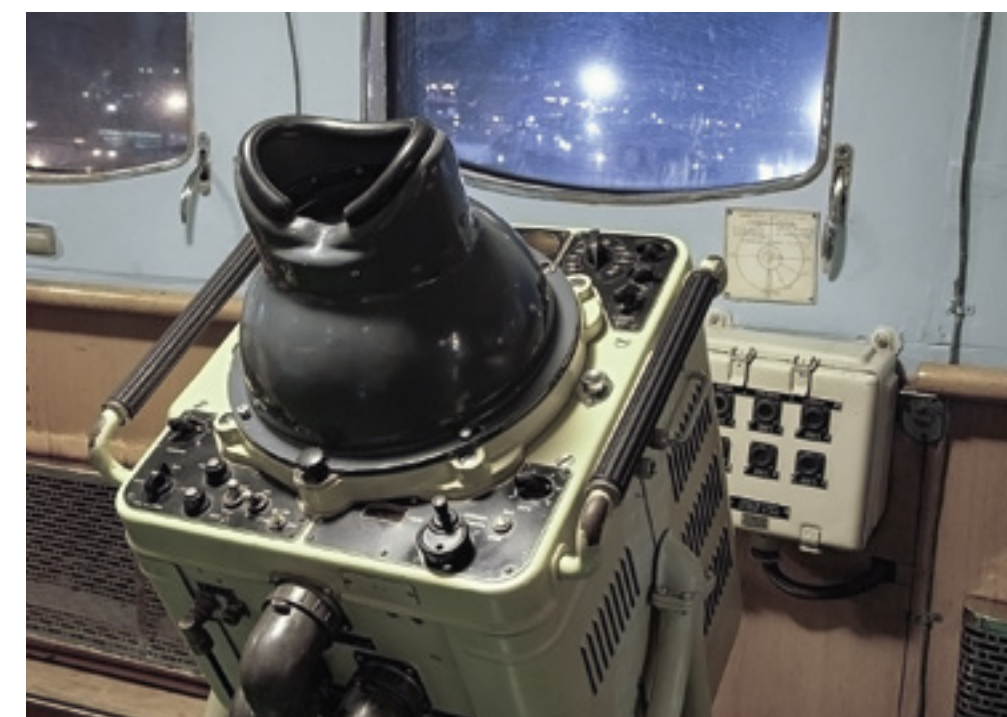
Индикатор кругового обзора (прибор И) навигационной радиолокационной станции «Дон» Предприятие п/я Г-4563, 1978 г.
