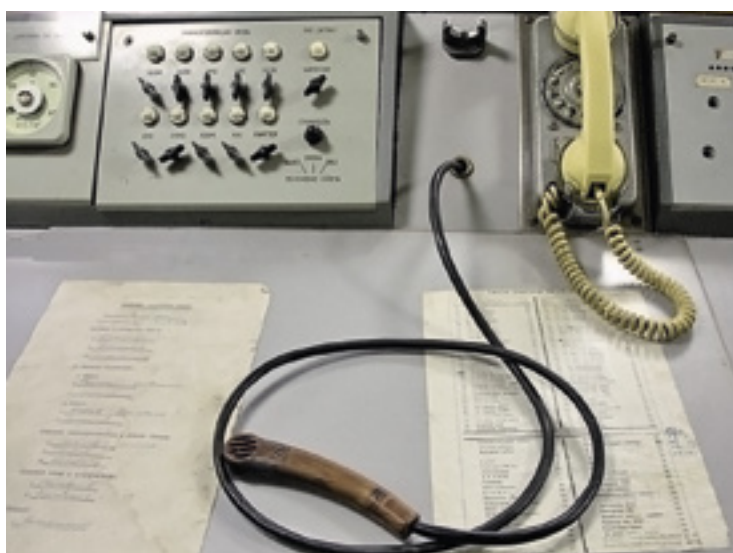
Выносной микрофон и панель системы унифицированной судовой громкоговорящей связи и трансляции «Березка»
