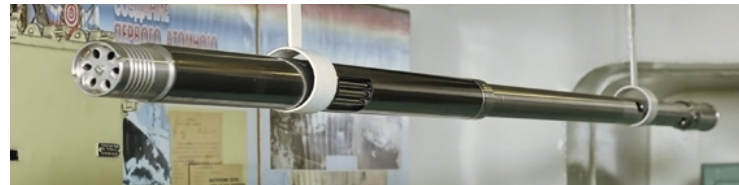
Макет тепловыделяющей сборки для АППУ ОК-900 в масштабе 1:1
